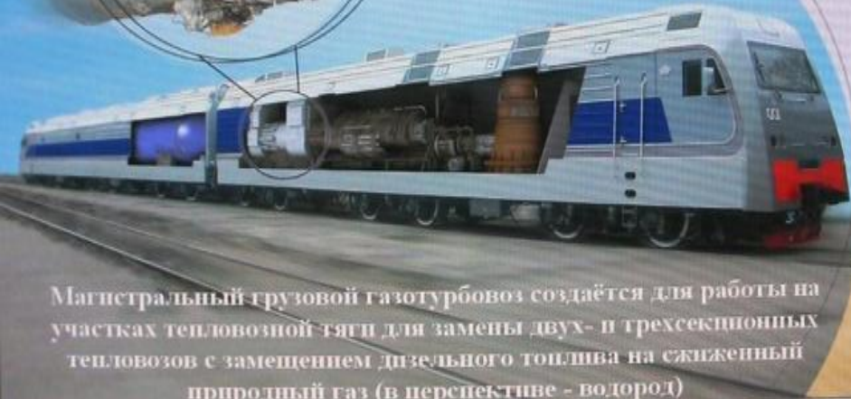
Рис. 5.25. Размещение оборудования на газотурбовозе ГТ-01 (общий вид и план) 1 – отсек с кабиной машиниста и высоковольтной камерой, 2 – отсек для газотурбинного двигателя, редуктора и тяговых генераторов постоянного тока, 3 – отсек для вспомогательного оборудования
