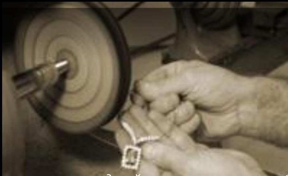
*Отделка ювелирных изделий - это окончательная обработка поверхности, доведение их до состояния товарного вида. Отделочные операции можно классифицировать по трем видам: механическая отделка - полирование, фактуровка, чеканка, гравирование; декоративно-защитные покрытия — эмалирование, чернение; химическая обработка — оксидирование и гальванопокрытия.*
