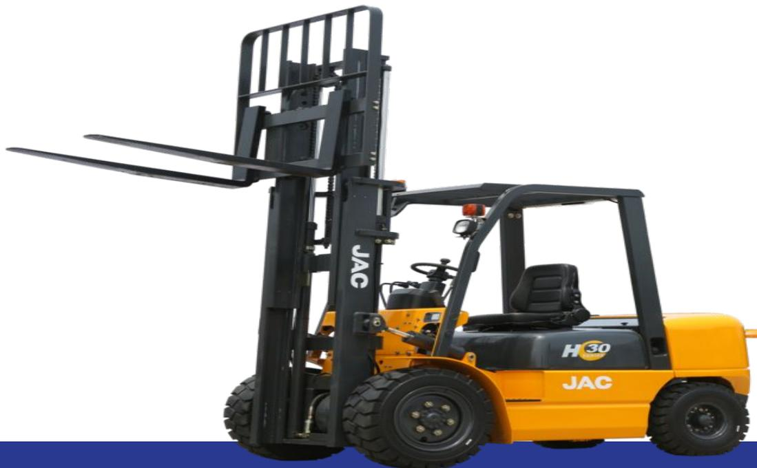
Автопогрузчики выпускают грузоподъемностью 2; 3,2; 5 и 10 т. Скорость передвижения погрузчиков с грузом - 6..15 км/ч, без груза - до 25 км/ч. Основным рабочим органом автопогрузчика является вилочный захват.
