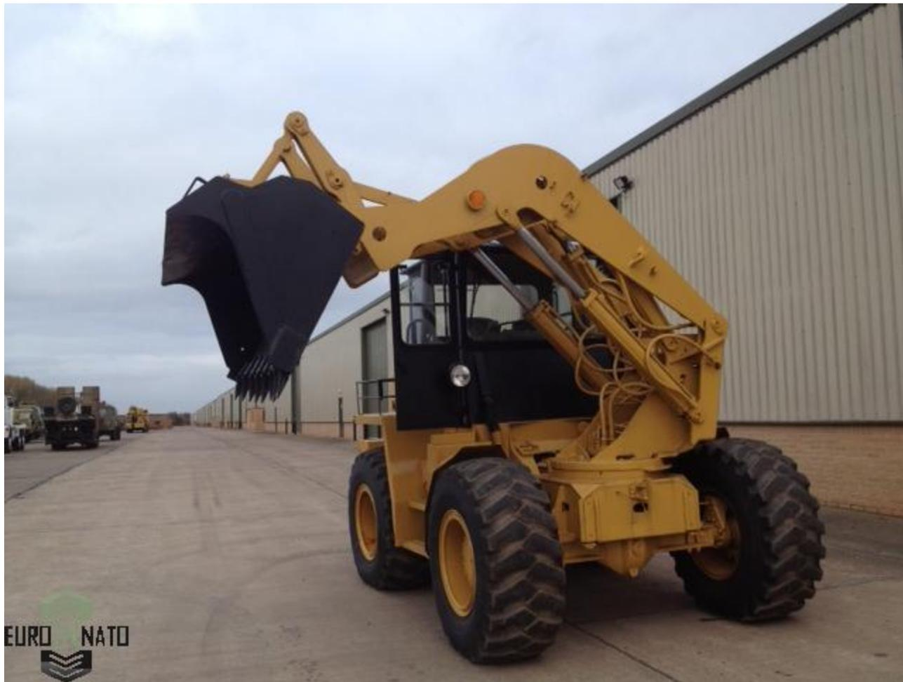
Наибольшее распространение нашли **фронтальные погрузчики на пневмоколесном ходу с шарнирно-сочлененной рамой**. Универсальность погрузчику придает широкая номенклатура сменного рабочего оборудования.
