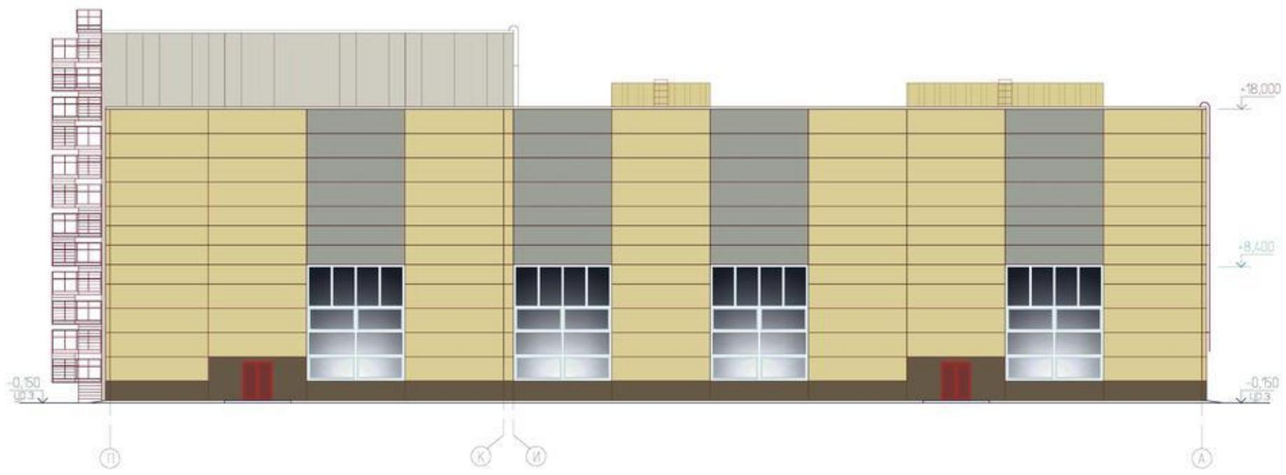
**Стены из крупных панелей** применяются для обеспечения полной сборности промышленного здания. Кроме того, использование крупных панелей ведет к сокращению трудоемкости и уменьшению массы здания.
