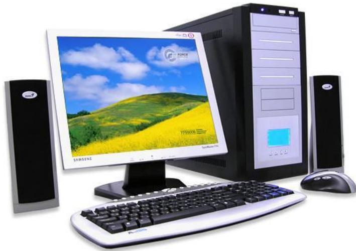
Для персональных компьютеров обязательно наличие монитора и ряда других периферийных устройств. В блоке ПК находятся материнская (системная) плата, процессор, различная память (ОЗУ, жесткий диск), устройства ввода-вывода, интерфейсы периферийных устройств и др.
