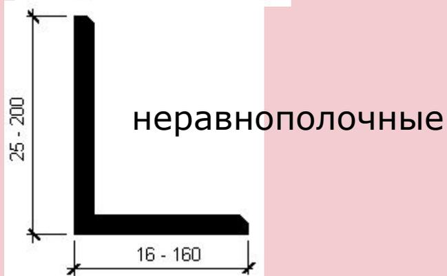
Уголки широко применяются при изготовлении легких сквозных конструкций.
