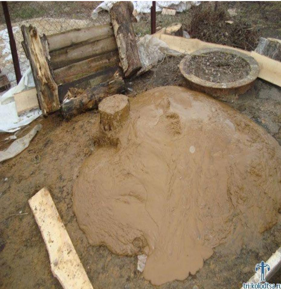
*Истинные плывуны* — это породы с коагуляционными или смешанными связями в виде глинистых песков, а также супесей, суглинков. Структурные связи обусловлены присутствием глинистых (менее 0,001 мм) частиц с высокими гидрофильными свойствами (коллоидов). Вокруг песчаных частиц формируются пленки связанной воды, что увеличивает их удельную поверхность и они всплывают под действием гидродинамического давления.
