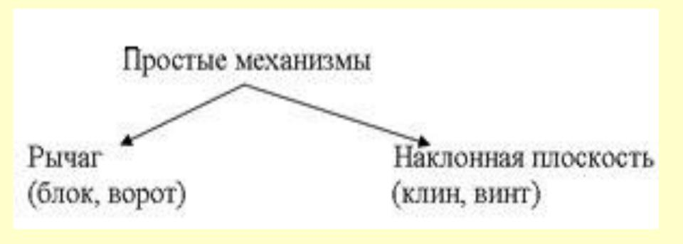
• Рычаг - твёрдое тело, которое может вращаться вокруг неподвижной опоры. Кратчайшее расстояние между точкой опоры и прямой, вдоль которой действует на рычаг сила, называется плечом силы.
