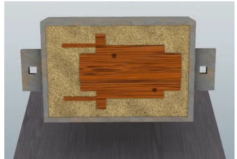
Переворот готовой полуформы на 180°
