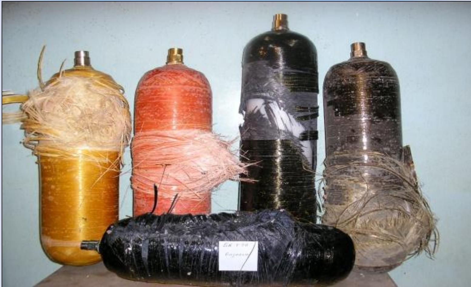
**Композиционный баллон после взрыва**
