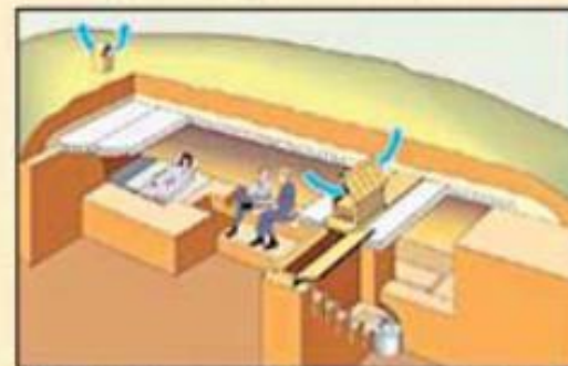
Быстровозводимое противорадиационное укрытие из железобетонных плит
