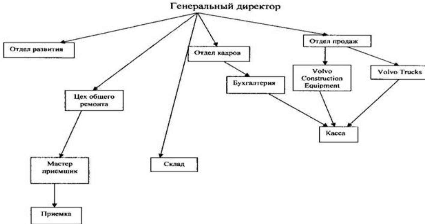
**Цех общего ремонта** – занимается приемкой и проведением осмотровых работ, проводит диагностические работы, техническое обслуживание, том числе: крепежные работы, регулировочные работы, смазочные работы, работы текущего ремонта, контроль качества выполняемых работ, выдачу автомобилей владельцам.
