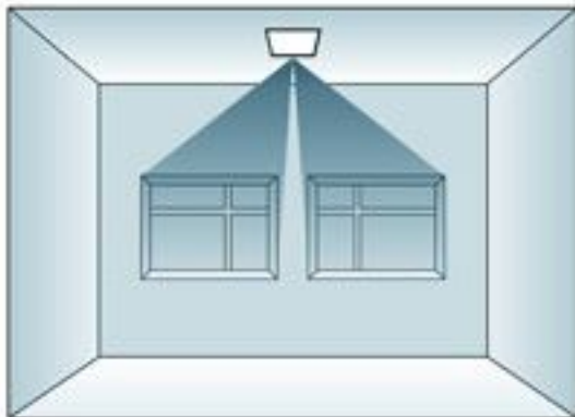
УСТАНОВКА ИЗВЕЩАТЕЛЯ НА ПОТОЛКЕ
