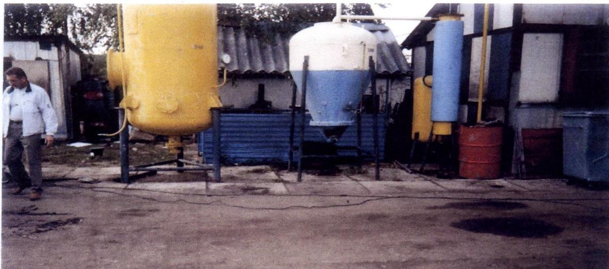
Экспериментальная пиролизная установка «У ТРО-1» для термической переработки изношенных автомобильных шин. Курьяновская промзона, район Люблино, Москва, 2009г
