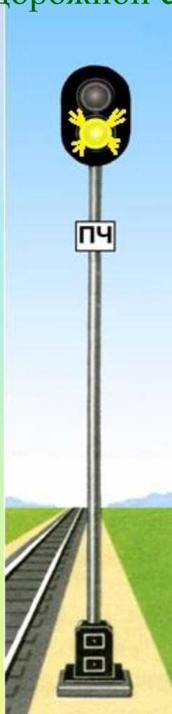
28. Повторительный светофор с одним зеленым огнем указывает, что выходной или маршрутный светофор открыт (рис. 53).
