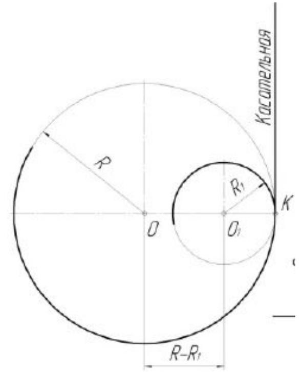
Расстояние между центрами касающихся дуг определяют как сумму ( $R + R_1$  – касание внешнее) или как разность ( $R - R_2$  – касание внутреннее) их радиусов.
