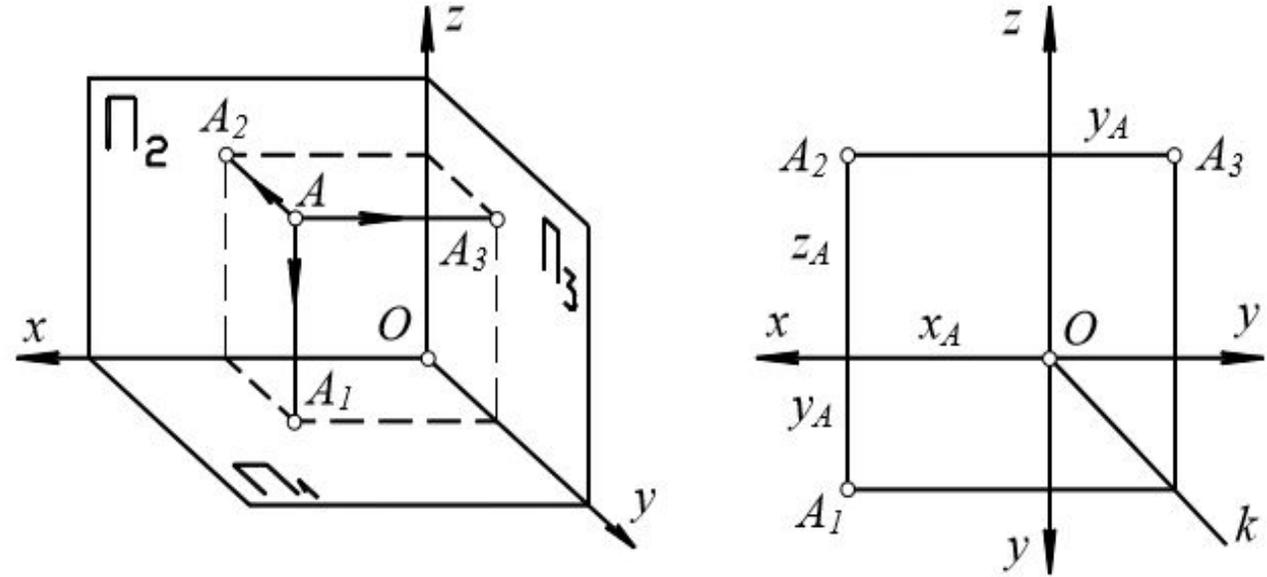
Получили **комплексный трехпроекционный чертеж** точки:
