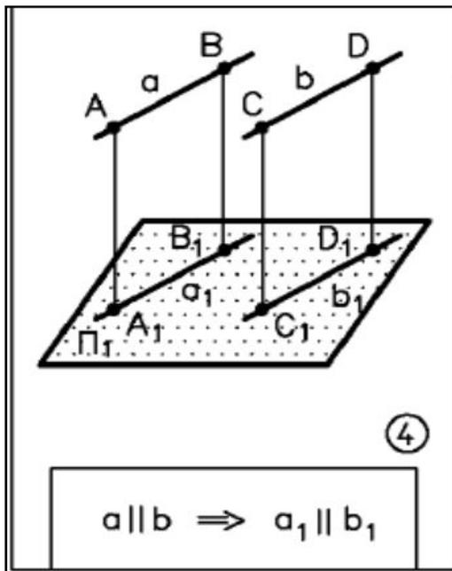
7. Если плоская геометрическая фигура параллельна плоскости проекций, то проекция этой фигуры на плоскость проекций конгруэнтна самой фигуре.
