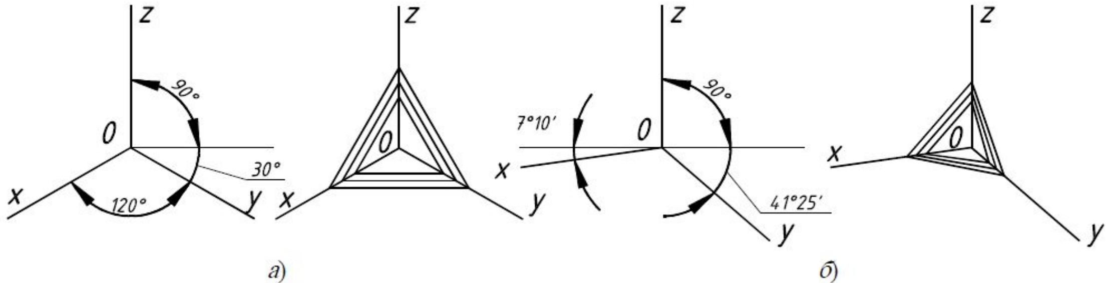
При построении осей пользуются транспортиром или уклонами осей. Уклоны осей – тангенсы углов  $30^\circ$ ,  $7^\circ 10'$  и  $41^\circ 25'$  приблизительно равны соответствующим отношениям  $3/5$ ,  $1/8$ ,  $7/8$  противолежащего катета к прилежащему.
