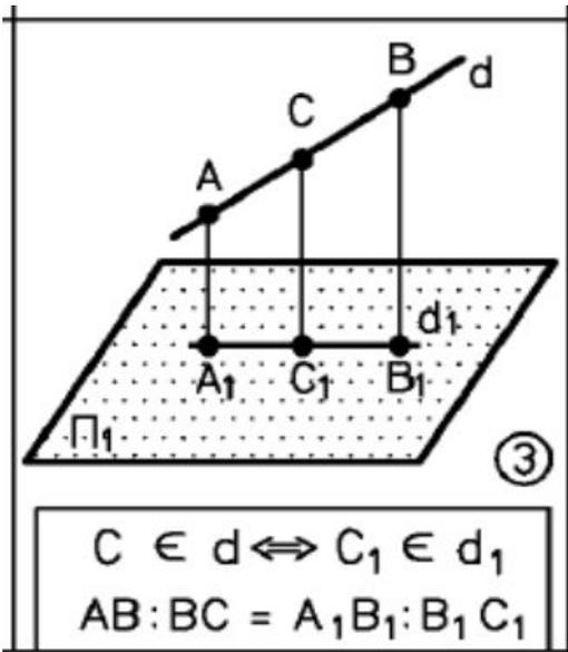
5. Проекция точки делит проекцию отрезка прямой в таком отношении, в каком точка делит заданный отрезок.
