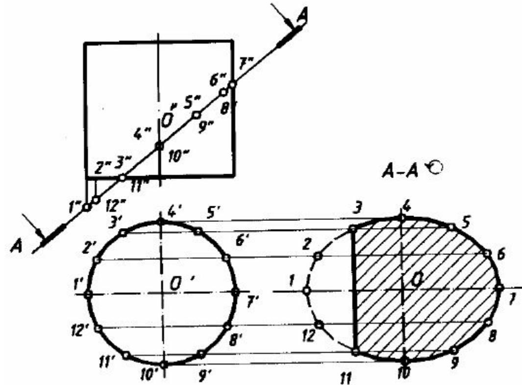
Наклонное сечение А–А можно повернуть, при этом нужно добавить условное графическое обозначение – знак "повёрнуто"
