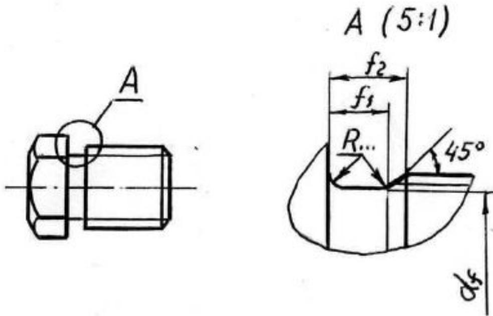
Если какая-либо часть предмета требует графического пояснения формы ввиду мелкого её изображения, то применяют дополнительное её изображение (обычно увеличенное), называемое **ВЫНОСНЫМ ЭЛЕМЕНТОМ**.
