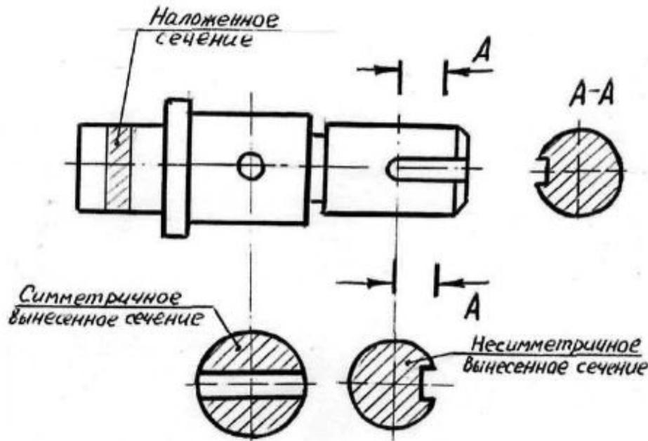
Вынесенное сечение может располагаться на свободном поле чертежа или в разрыве изображения предмета. Контур вынесенного сечения изображается сплошными основными линиями.
