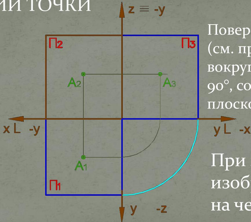
Повернув плоскости  $\pi_1$  и  $\pi_3$  (см. предыдущий слайд) вокруг осей проекций на угол  $90^\circ$ , совместим их с плоскостью  $\pi_2$
