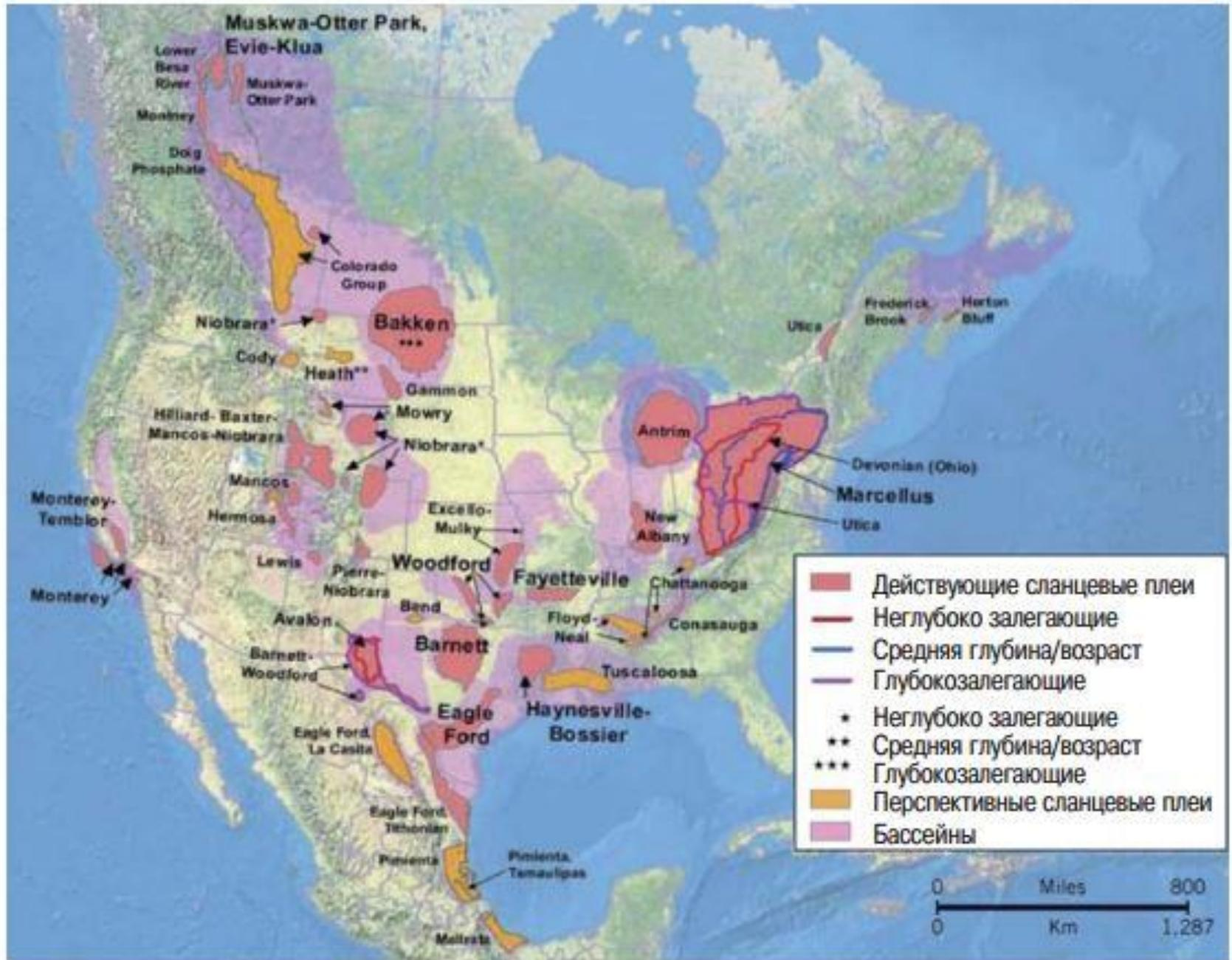
Рис. 7. Месторождения сланцевого газа и нефти плотных пород в Северной Америке
