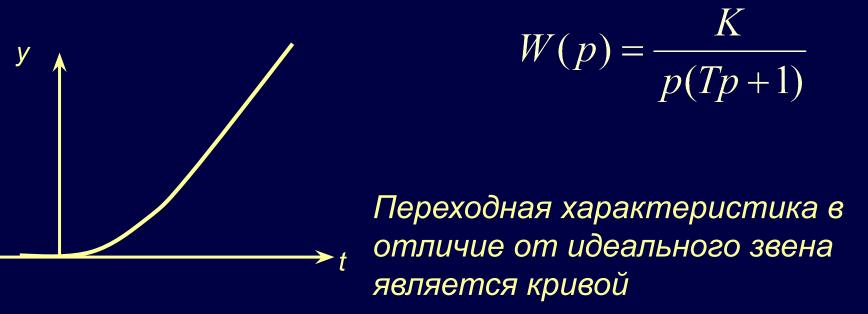
Примером интегрирующего звена является двигатель постоянного тока с независимым возбуждением, если в качестве входного воздействия принять напряжение питания статора, а выходного - угол поворота ротора.
