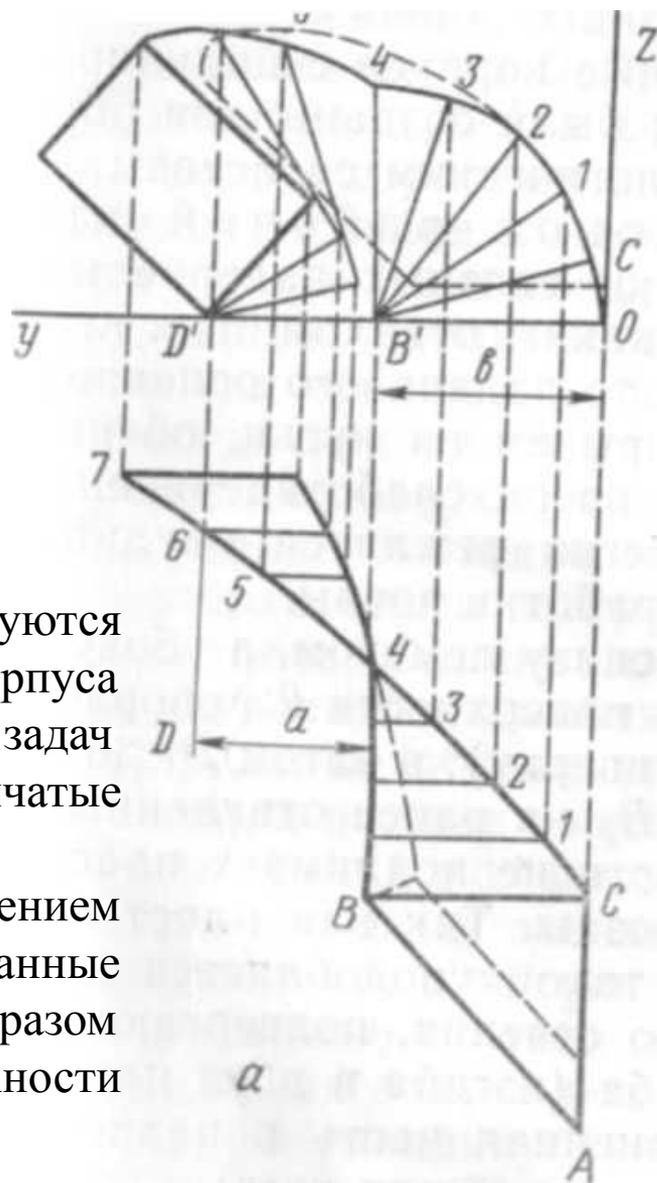
Применительно к плужному корпусу наиболее просто рабочую поверхность можно получить, если перемещать прямолинейную образующую параллельно дну борозды по кривым, расположенным одна в плоскости  $ZOX$  стенки борозды, а другая в вертикальной плоскости  $V$ , перпендикулярной лезвию лемеха, получается так называемый горизонтальный цилиндрический цилиндр.
