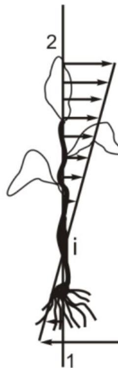
Для обеспечения условия  $V_m + V_p = 0$  необходимо, чтобы в некоторый промежуток времени, необходимый для высадки рассады, линейная скорость захвата аппарата была равна скорости машины и противоположно ей направлена.
