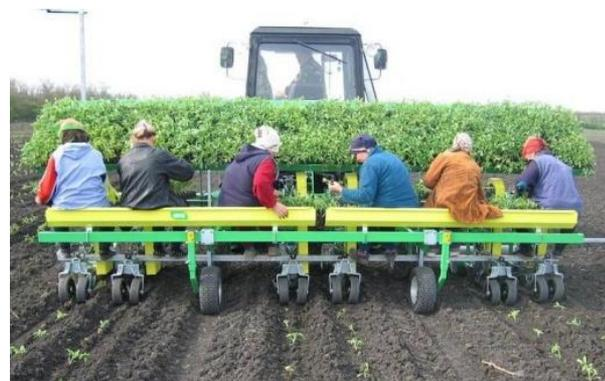
Существенной особенностью рабочего процесса рассадопосадочной машины является то, что укладка рассады в открытую борозду и заделка ее почвой производится на ходу при определенной скорости  $V_m$
