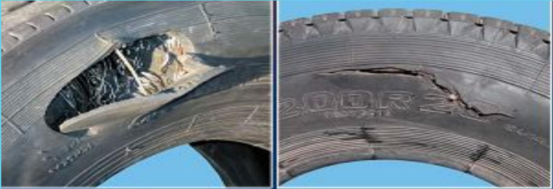
Причины: разрыв каркаса вследствие резкой деформации профиля шины при ударе о дорожное препятствие; воздействие на шину предметов с острыми краями (камней, металла и др.)
