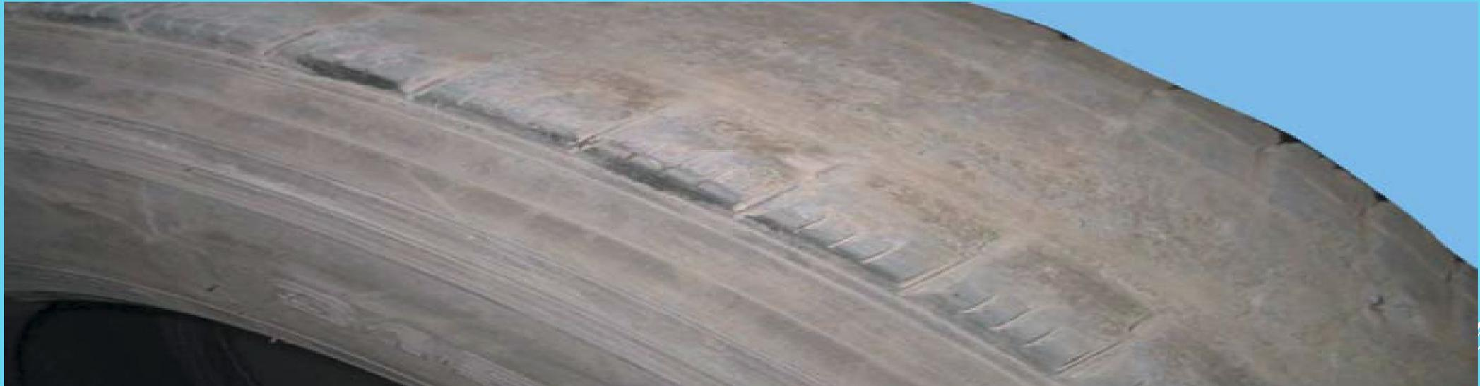
Причина: а) эксплуатация шины с повышенным относительно нормы внутренним давлением; б) эксплуатация шины без нагрузки.
