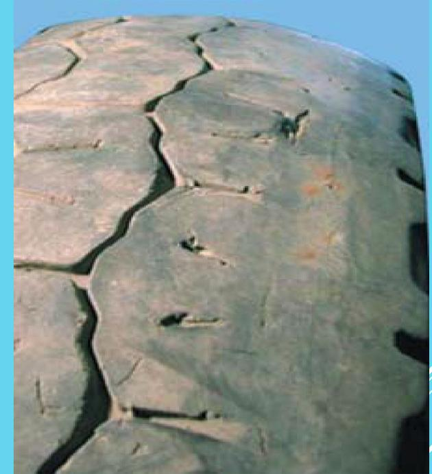
Причины: а)выработка ресурса шины; б)эксплуатация шины на повышенном внутреннем давлении; в)особенности эксплуатации – частые ускорения и торможения, в частности на горных дорогах; г)неисправность ходовой части транспортного средства.
