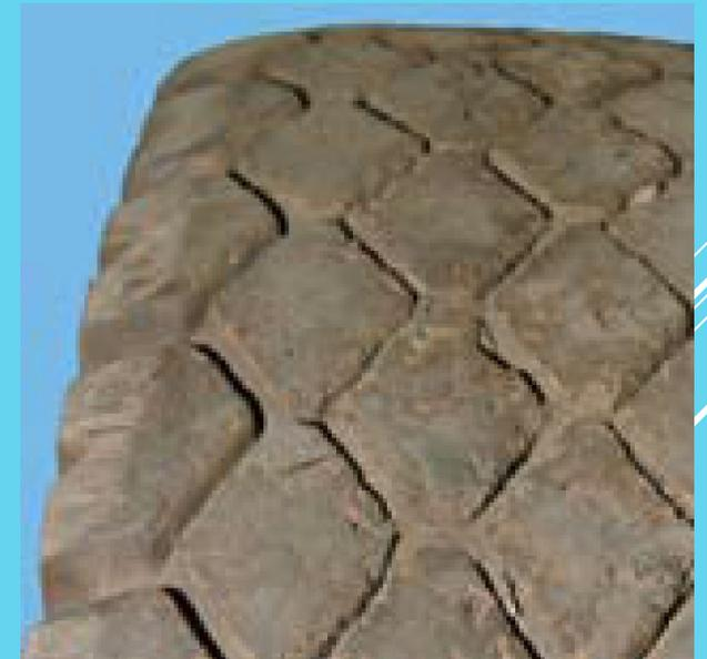
Причины: эксплуатация шин на дорогах с неусовершенствованным, абразивным и изношенным покрытием, а так же по щебню и камням
