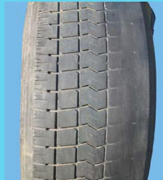
Причины: неправильный развал колес в положительном или отрицательном направлении; покосилась или изогнулась ось автомобиля.
