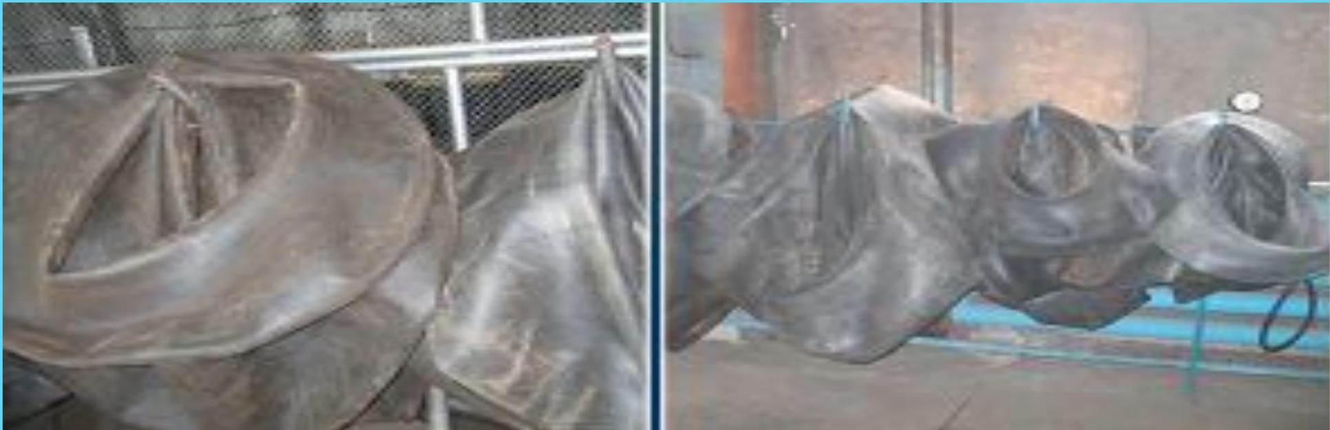
**Рекомендации:** камеры должны храниться в слегка накаченном воздухом состоянии на кронштейнах с полукруглыми поверхностями или в крышках. Через каждые 3 месяца хранения на кронштейнах камеры следует поворачивать, меняя зону опоры
