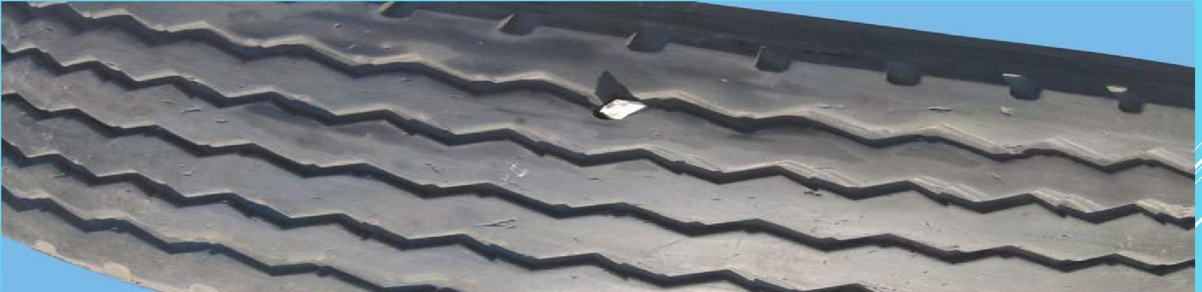
Причина: наезд шины на твердый предмет с острой кромкой
