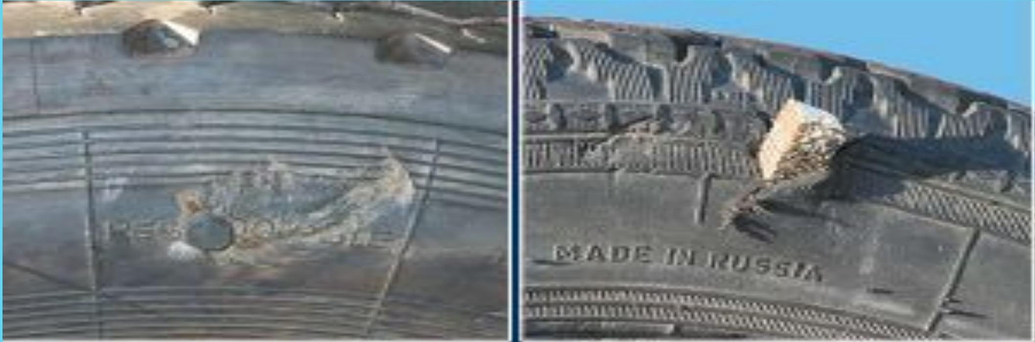
Причины: попадание камней и других посторонних предметов между сдвоенными шинами на задней оси транспортного средства. Результат - повреждение боковины, разрыв каркаса
