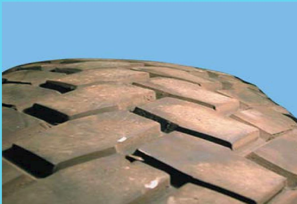
Причины: эксплуатация шины с пониженным относительно нормы внутренним давлением; эксплуатация с перегрузом.
