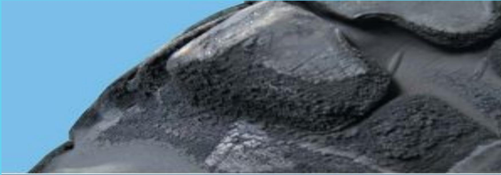
Причины: последствия воздействия агрессивных жидкостей
