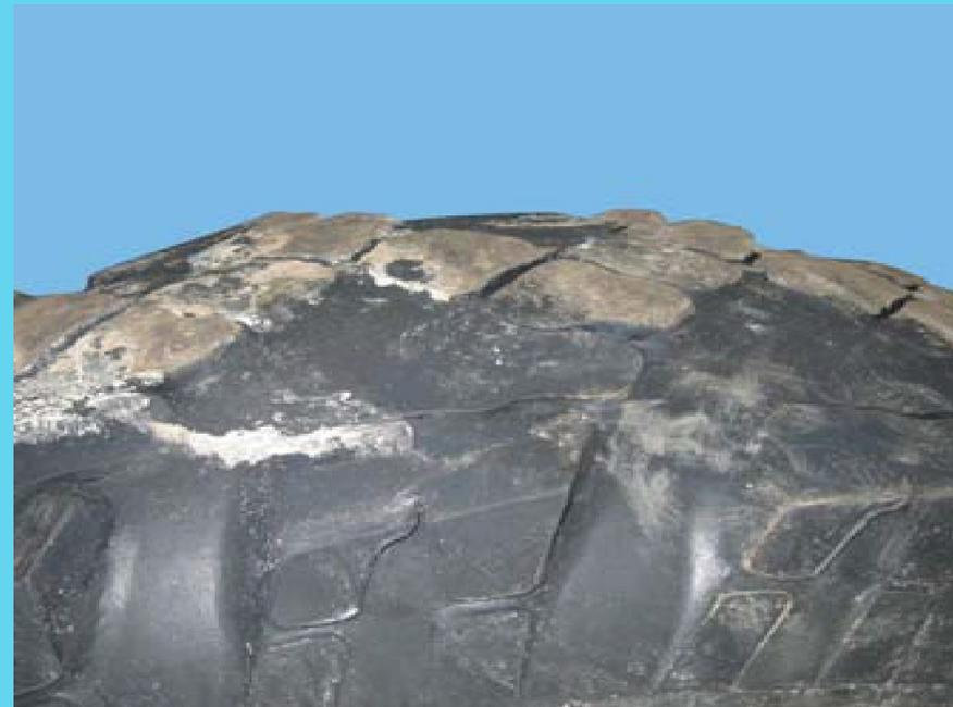
Причины: разница в наружных диаметрах сдвоенных шин; разное давление в сдвоенных шинах; неисправная (поврежденная) подвеска.
