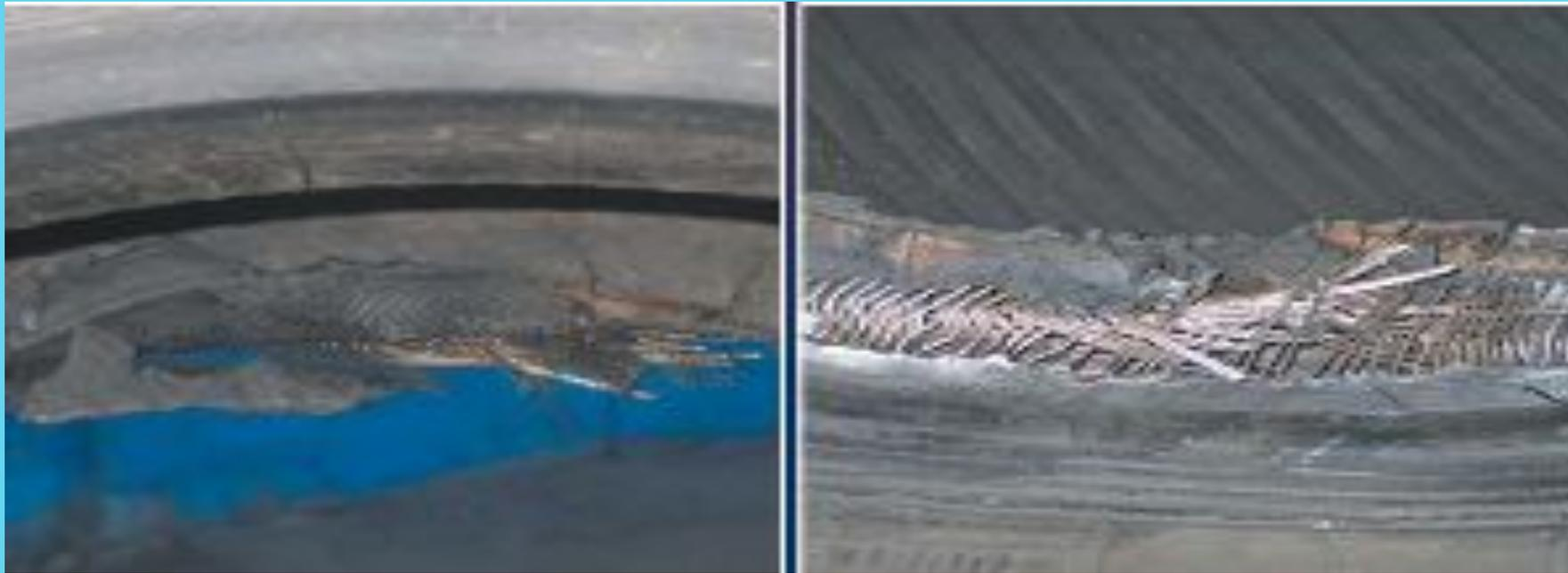
Причины: неисправная тормозная система; длительное торможение
