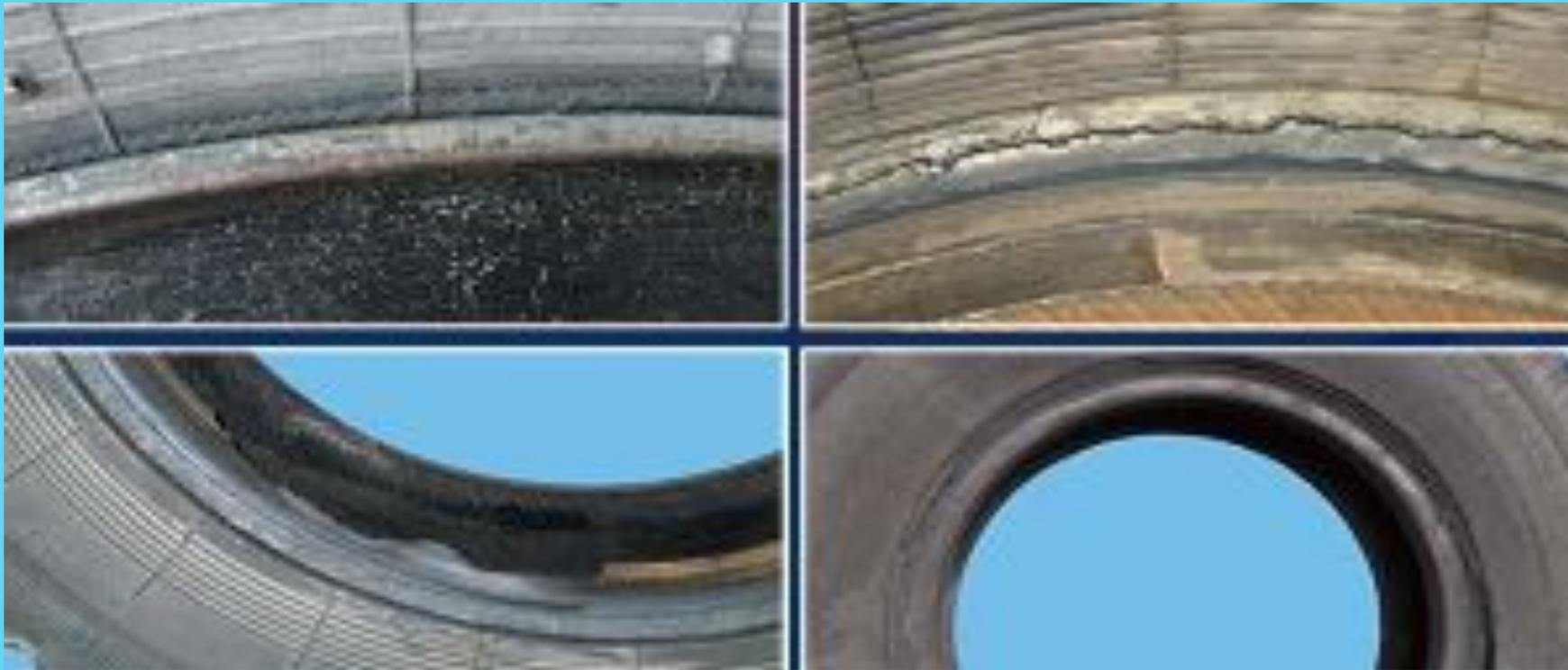
Причины: эксплуатация с перегрузом
