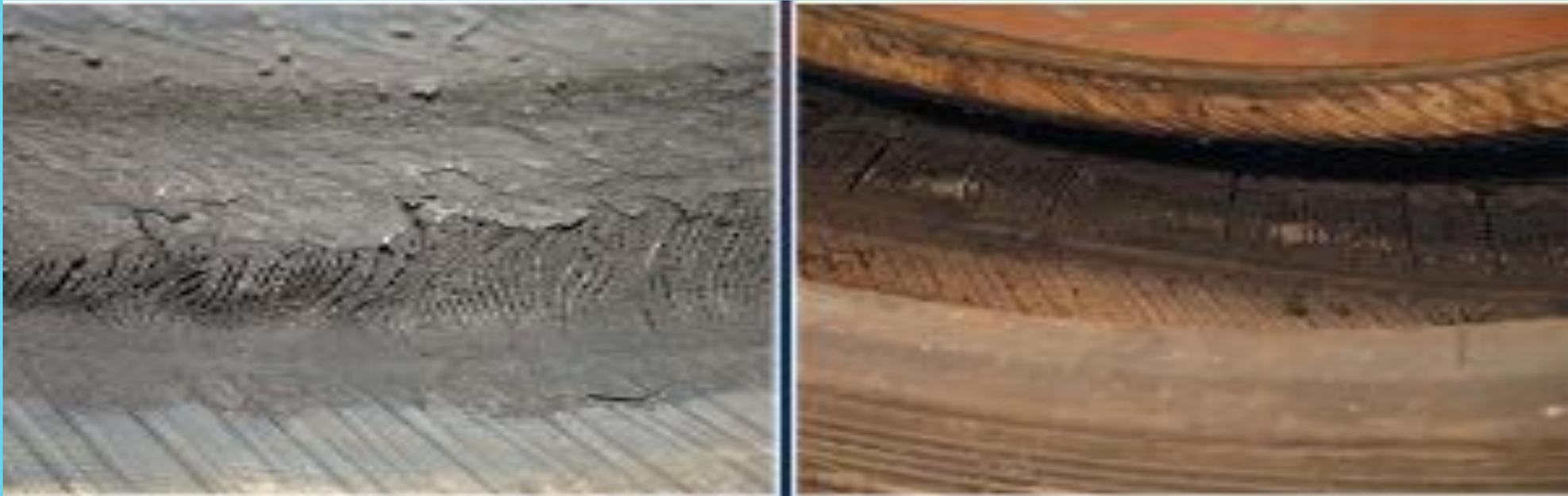
Причины: езда на пониженном или снижающемся рабочем давлении в шине; при механическом повреждении шины.
