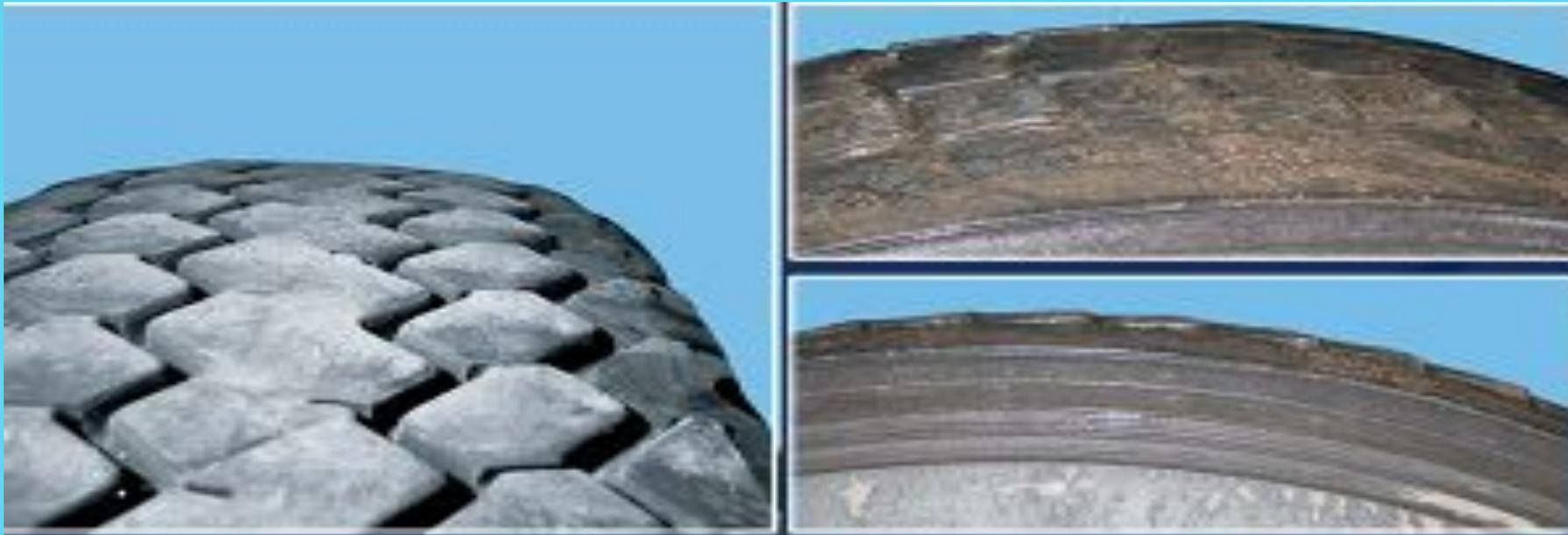
Причины: техническая неисправность автомобиля (несоответствие углов схода и развала колёс их нормативным значениям, неисправность амортизаторов или тормозов)
