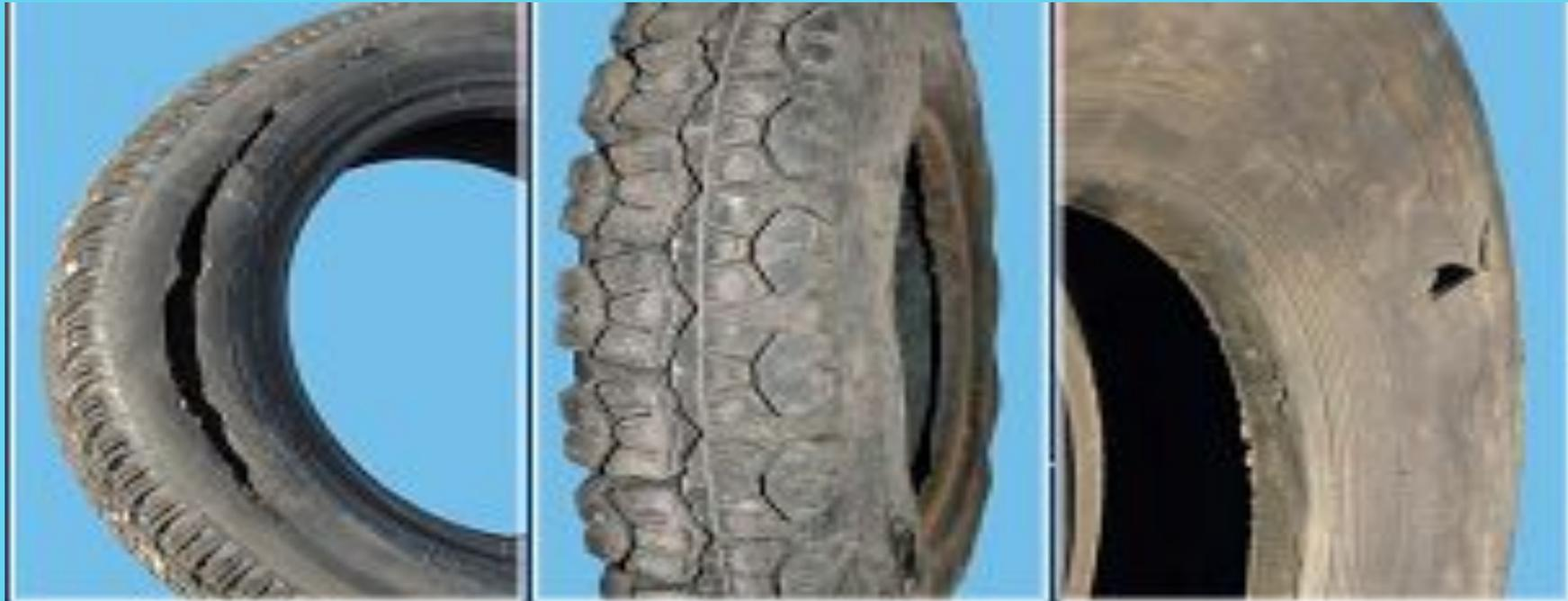
Причины: езда на пониженном или снижающемся рабочем давлением в шине; при механическом повреждении шины.
