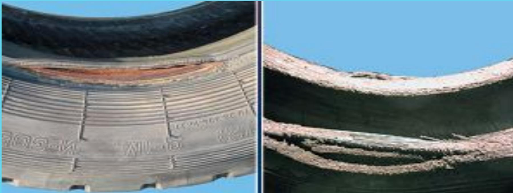
Причины: эксплуатация с перегрузом, использование неисправных и неподходящих ободов
