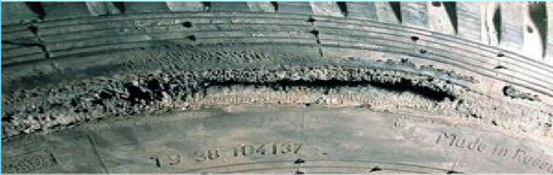
Причины: повреждения боковины предметами, возвышающимися над дорожным покрытием; касание шины о выступающие детали автомобиля
