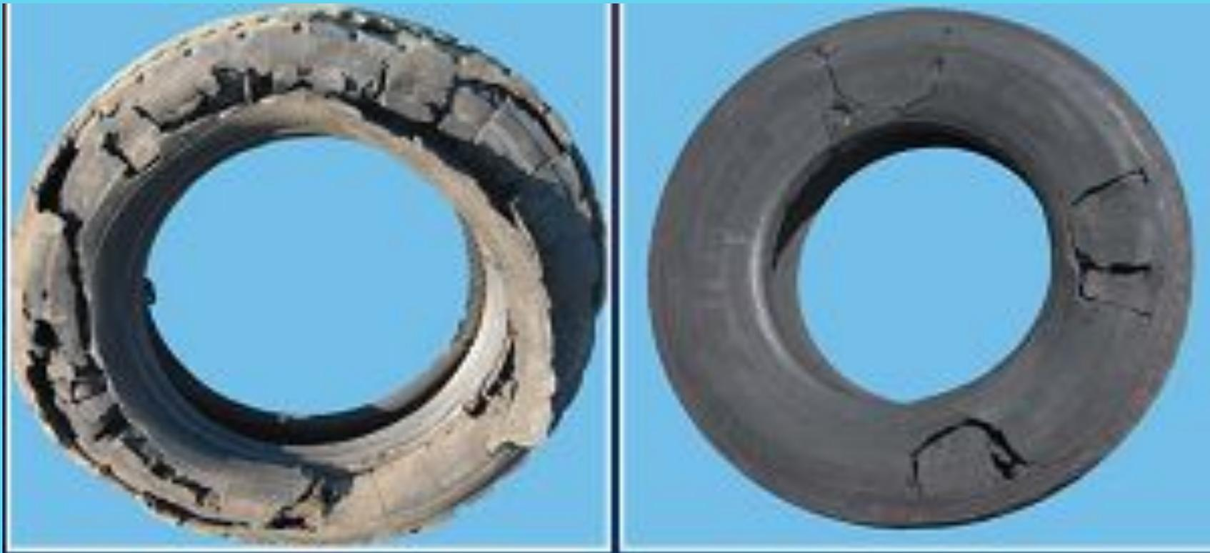
Причины: езда на пониженном или снижающемся рабочем давлении в шине; при механическом повреждении шины.
