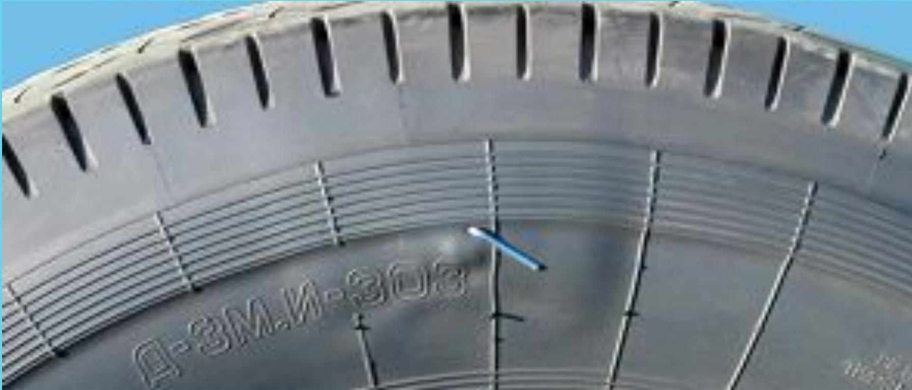
Причины: механическое повреждение боковины острыми предметами в процессе эксплуатации
