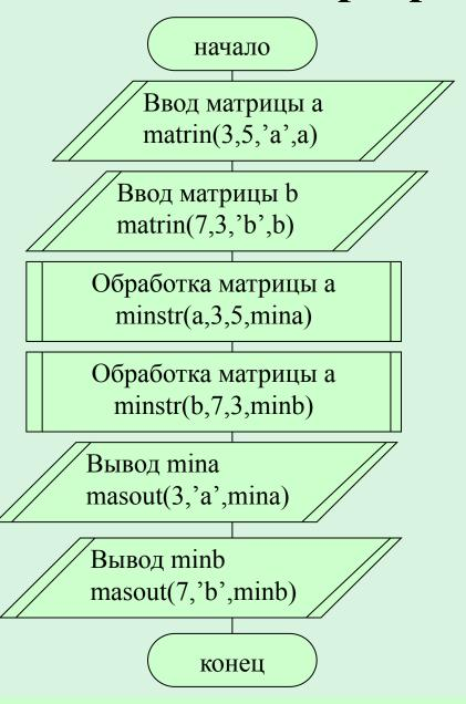
Блок-схема функции определения минимальных значений строк матрицы
