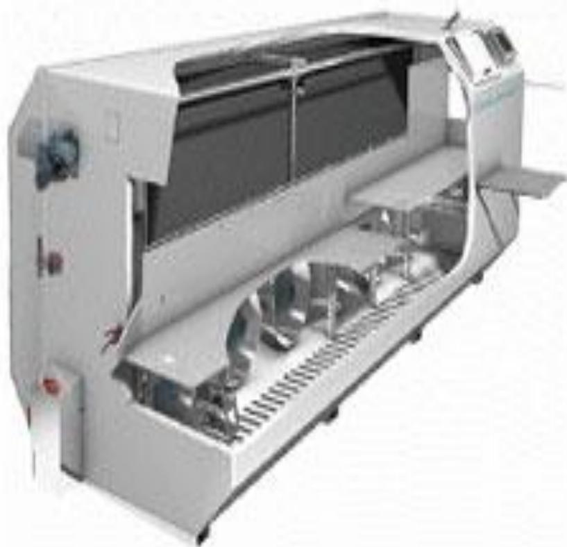
Компания «Ягоды Карелии» использует технологии, которые позволяют заморозить продукт за минимальное время в потоке холодного воздуха. Особенностью данных технологий замораживания продукции являются такие параметры, как: температура воздуха в скороморозильном туннеле или шоковой камере —  $37-42^{\circ}\text{C}$ , средняя скорость движения воздуха  $3,6 \text{ м/с}$ , скорость замораживания  $30-240 \text{ мин}$ , температура в сердцевине продукта после замораживания —  $18^{\circ}\text{C}$ .
