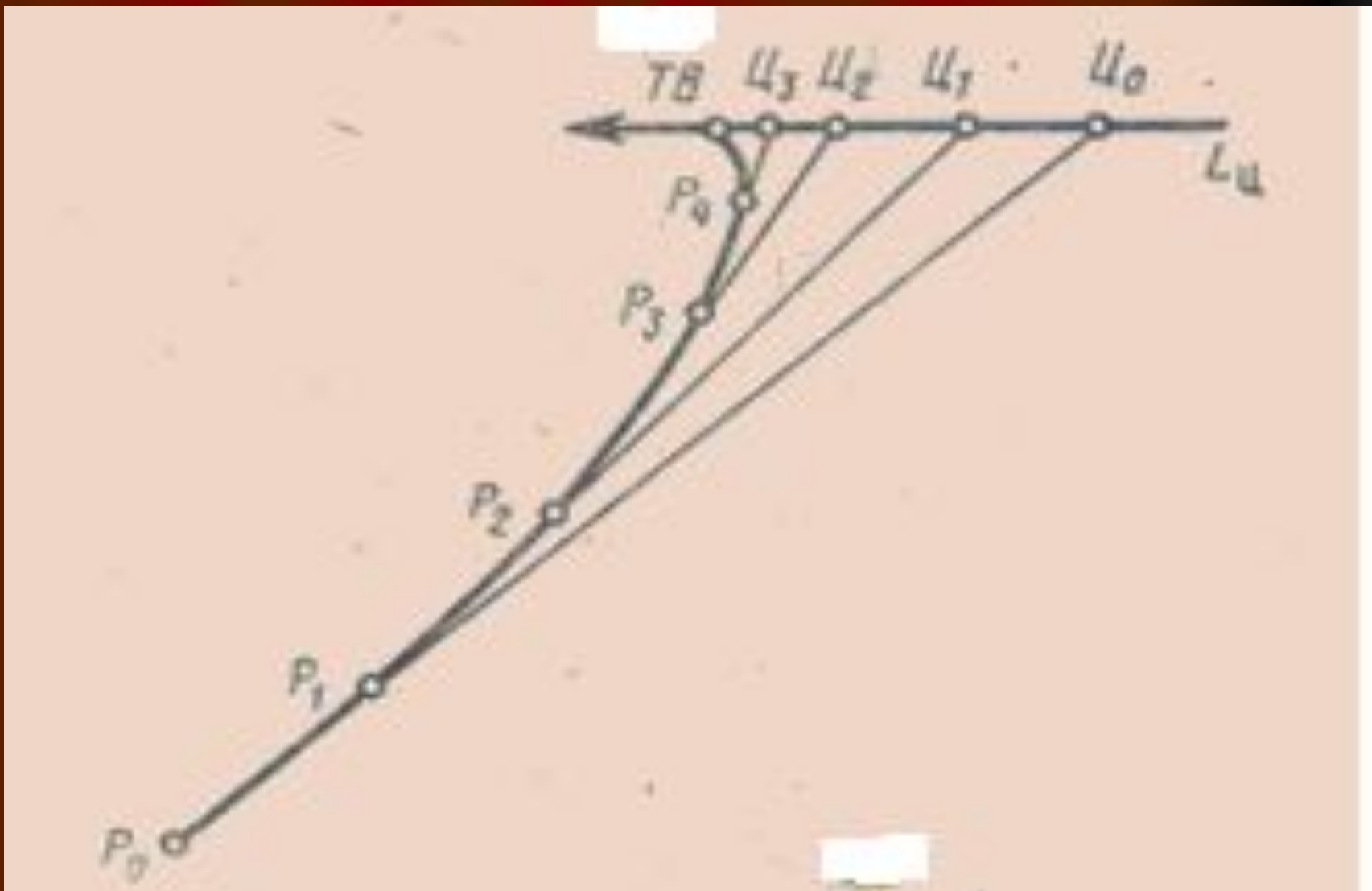
Рис.2 Графическое изображение траектории полёта ЗУР при методе погони.
