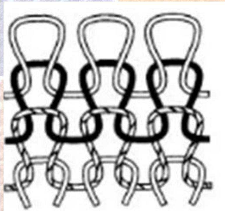
**Цепочка** — простой вид основовязаного переплетения. Цепочка — вертикальный ряд петель, вырабатываемый из одной нити на каждой игле машины.
