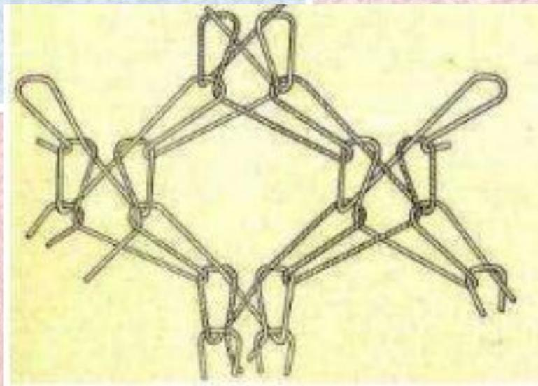
**Прессовый трикотаж** — полотно, в котором нить на иглы вязальной машины прокладывается всегда, но сбрасывается в зависимости от рисунка. В результате в структуре полотна образуются прессовые петли, отличающиеся от обычных большей высотой и имеющие наброски.
