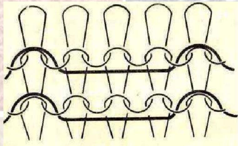
**Плюшевое переплетение** — полотно характеризуется ворсовой поверхностью, которая образуется прокладыванием на каждую иглу по две нити, при этом остовы петель у них одинаковые, а протяжки имеют разную длину.
