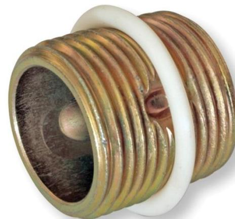
Соединение секций TENRAD осуществляется с помощью стальных ниппелей с кадмиевым покрытием стойким к коррозии и уплотнительными кольцами из Elastoseal R710/60 (силиконовый каучук).
