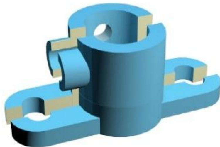
*Простыми называются разрезы при одной секущей плоскости.*
