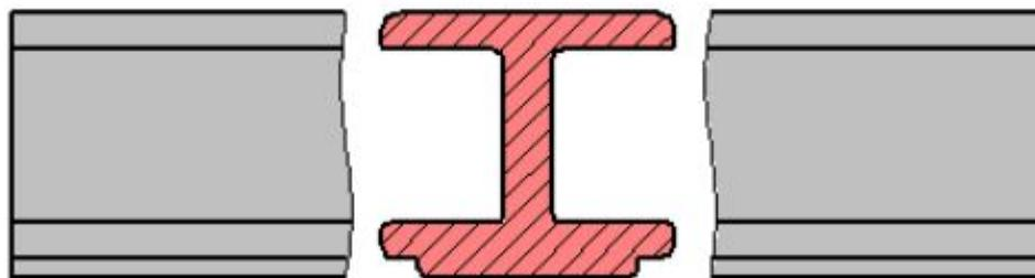
Для нескольких одинаковых сечений одного и того же предмета линии сечения обозначают одной буквой и вычерчивают одно сечение. Если при этом секущие плоскости направлены под разными углами, то знак «Повернуто» не наносят
