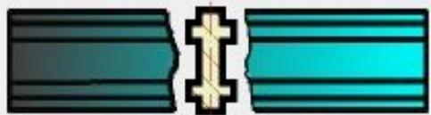
*Контур вынесенного сечения изображают сплошными основными линиями, а контур наложенного сечения- сплошными тонкими линиями, причем контур изображения в месте расположения наложенного сечения не прерывают.*
