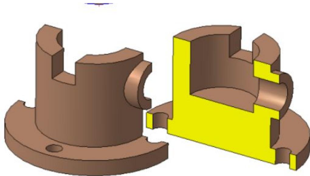
Разрез, служащий для выяснения устройства предмета лишь в отдельном, ограниченном месте, называется *местным*. Местный разрез выделяется на виде сплошной волнистой линией или сплошной тонкой линией с изломом. Эти линии не должны совпадать с какими-либо другими линиями изображения
