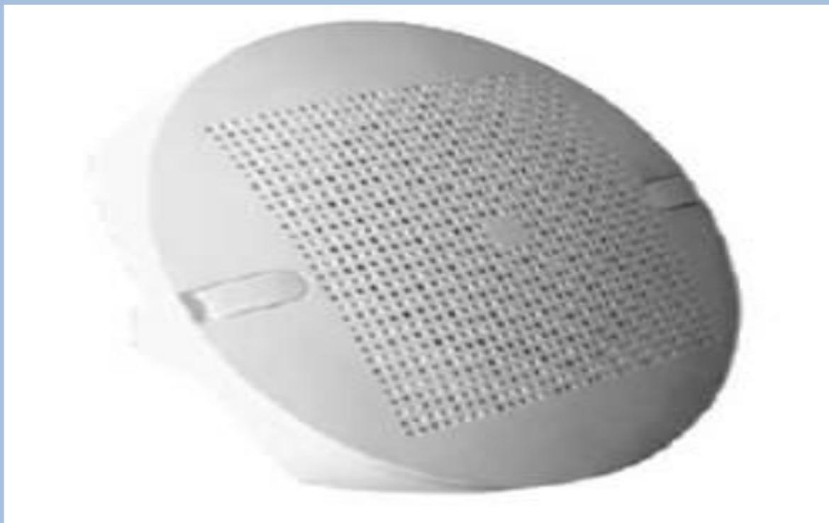
*В здании общежития № 4 БашГУ речевой оповещатель «Орфей» устанавливается в коридорах каждого этажа, согласно акустического расчета, расстояние между оповещателями равно 13,5 м.*
