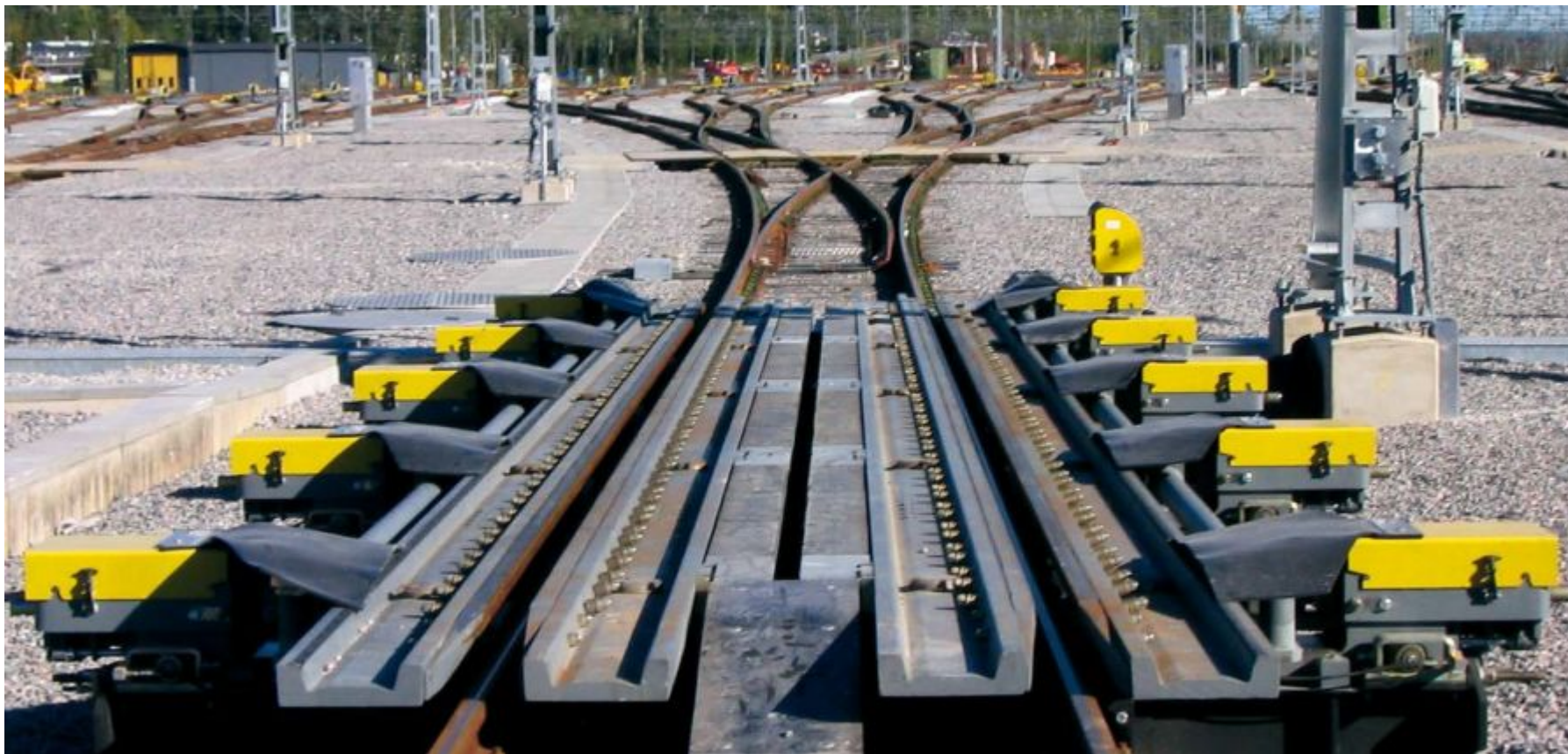
Trackguard Retarder TW-F рычажный фрикционный тормоз с пятью силовыми агрегатами
