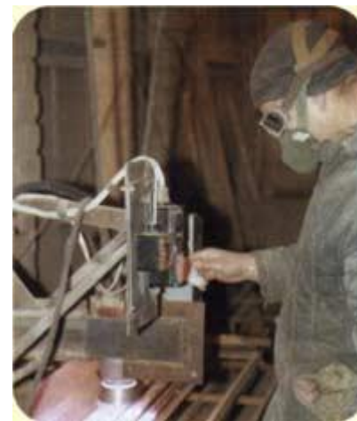
Нанесение латунного ЭМП на бойлерные трубки
