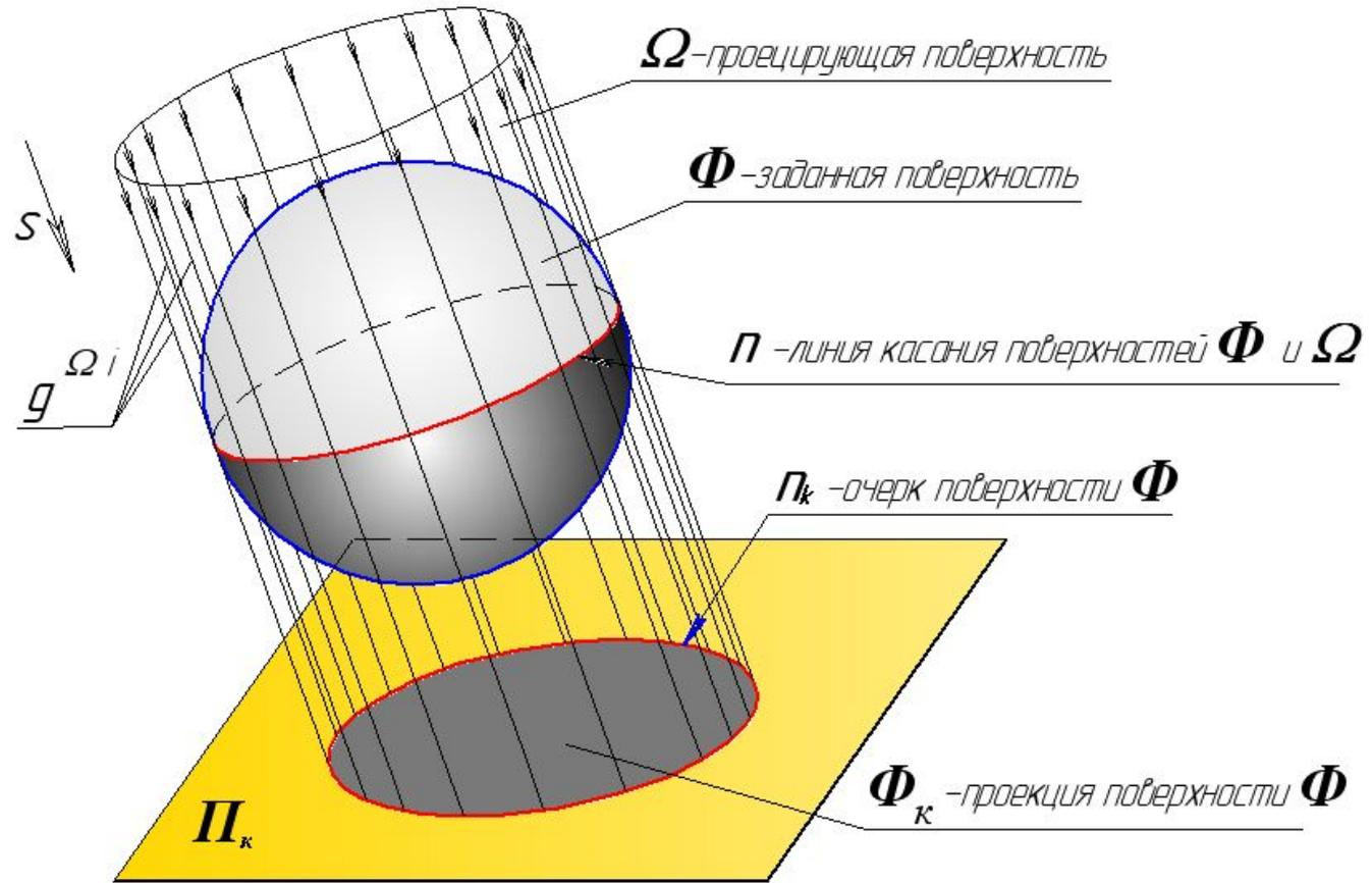
**Очерк поверхности** – это линия пересечения плоскости проекций с проецирующей поверхностью, касательной к заданной поверхности и ее охватывающей.
