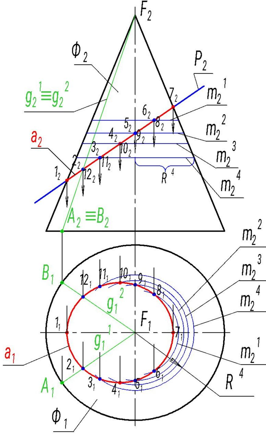
Данная коническая поверхность относится к классу линейчатых и подклассу поверхностей вращения. Следовательно, для построения точки на поверхности можно использовать, как прямую линия (образующую), так и окружность (параллель).
