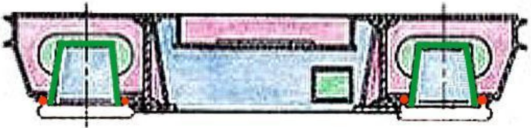
В нижней части рамы на листах толщиной **18 мм**, усиленных сверху перегородками, приварены два шкворня на расстоянии **8600 мм** друг от друга по продольной оси тепловоза.
