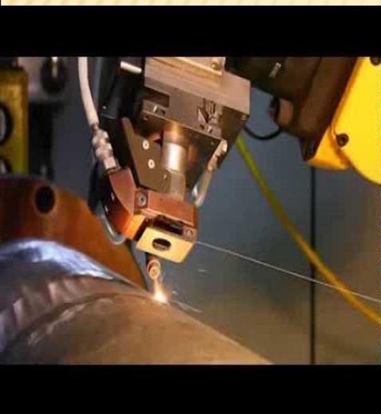
Рис. 2 Схема наплавки с боковой подачей порошка
