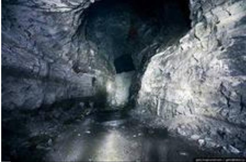
**Восстающий** — наклонная выработка, не имеющая непосредственного выхода на поверхность и предназначенная для спуска различных грузов под действием собственного веса.
