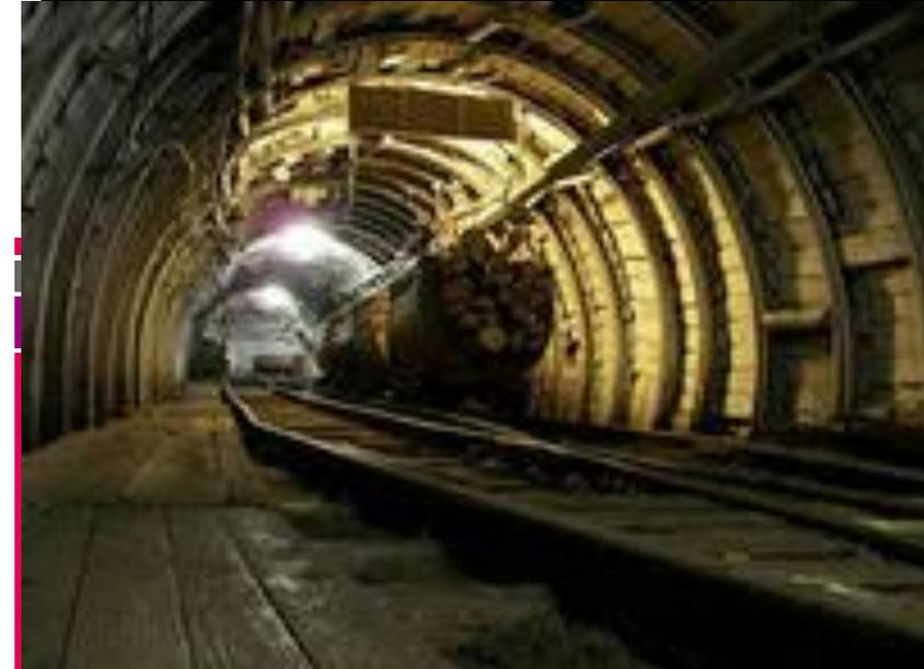
**Бремсберг** — подземная наклонная горная выработка (не имеющая выхода на поверхность), проводимая, как правило, по направлению падения пласта или залежи полезного ископаемого на откаточный горизонт этажа или шахты.
