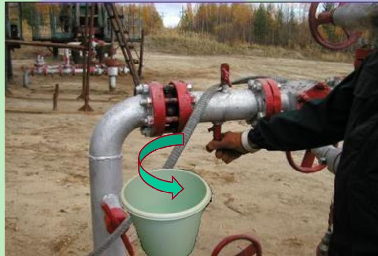
Перед отбором проб нефти следует тщательно осмотреть пробоотборник, посуду для налива проб и корзины для их переноски от места отбора до лаборатории.
