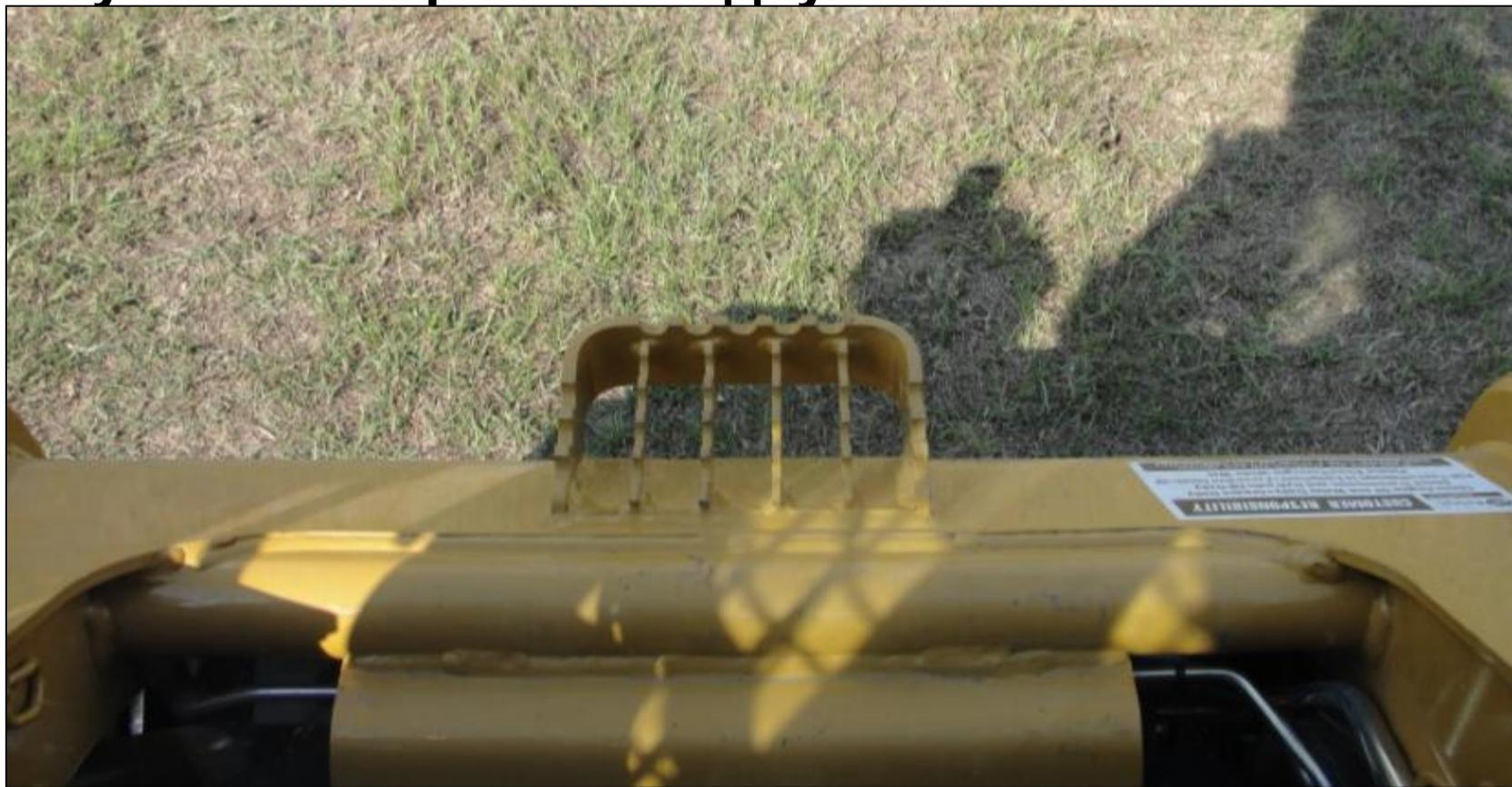
**Б/С каретка фактически невидима из кабины из-за поперечной балки**
