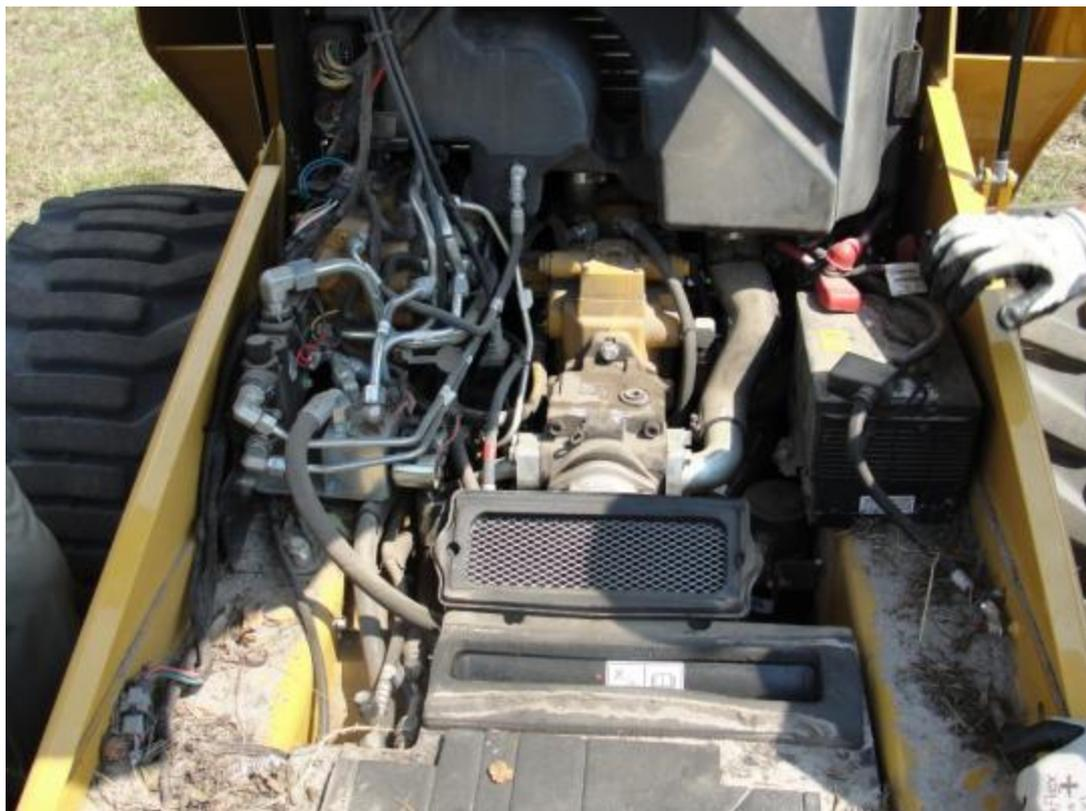
Система кондиционирования закрывает доступ ко ключевым компонентам гидравлики. Для доступа к ним кондиционер должен быть снят, давление в системе сброшено
