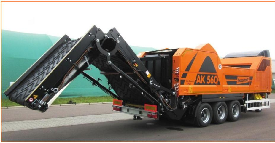
Нижний конвейер – длина 1.400 мм, ширина 1.750 мм
