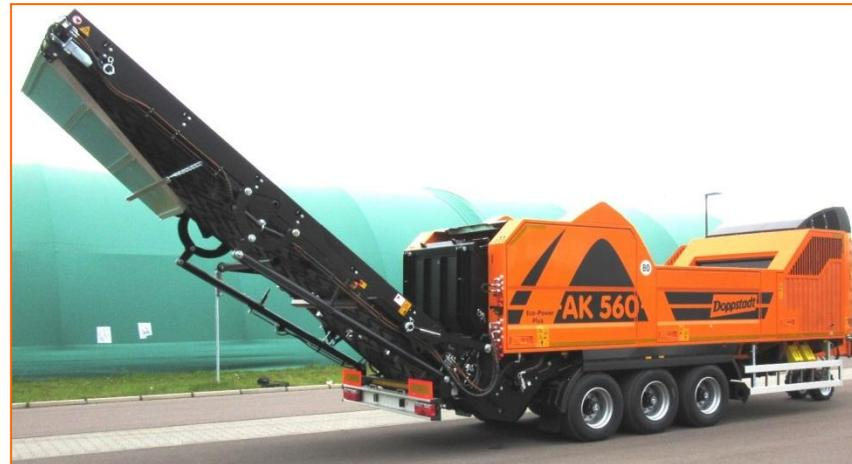
Нижний перегрузочный конвейер перемещает материал на задний конвейер
