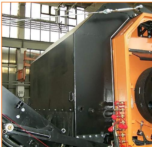
Система пылеподавления Форсунки перед подающим барабаном
