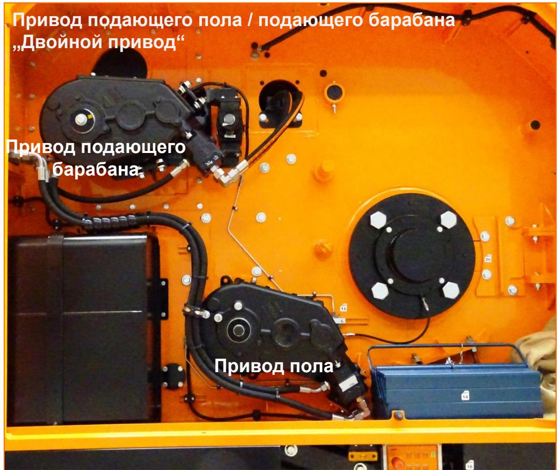
Скорость подающего барабана и пола регулируются отдельно на дисплее
