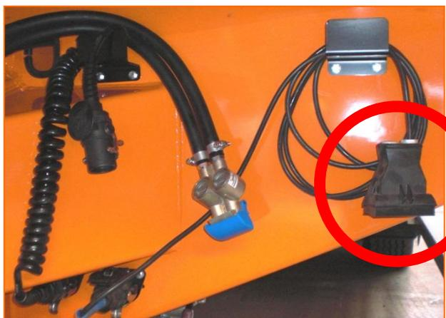
**Дополнительный гидровыход 20 л/мин, Требуется для поперечного магнита**
