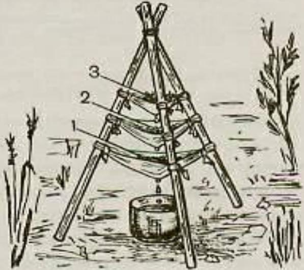
Рис. 15. Фильтрация воды:
