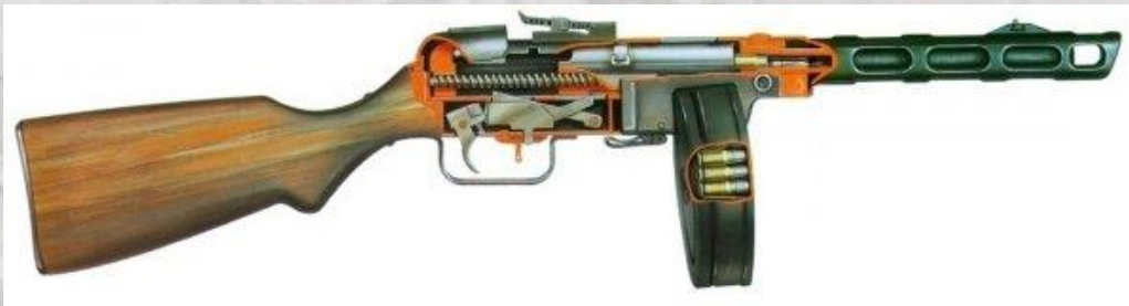
Схема устройства ППШ-41 с секторным прицелом
