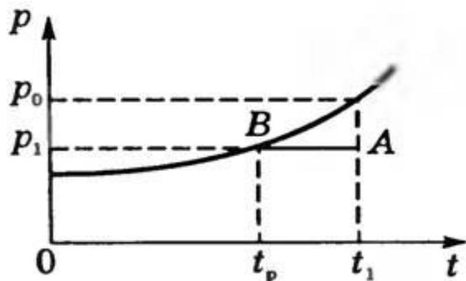
Пусть при температуре  $t_1$  упругость водяного пара  $p_1$ . Состояние пара на диаграмме  $p, t$  изобразится точкой  $A$ .
