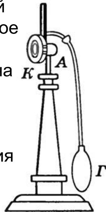
**Волосяной гигрометр**, в котором деталь, чувствительной к изменению влажности, служит обезжиренный человеческий волос [1]. Он закреплен в верхней части прибора [2], обернут вокруг ролика [3] и натянут при помощи специально подобранного груза [4]. К ролику прикреплена стрелка [5]. При увеличении относительной влажности воздуха волос удлиняется и вызывает вращение ролика вместе со стрелкой. Стрелка, передвигаясь по шкале, указывает значение влажности воздуха, выраженное в процентах.
