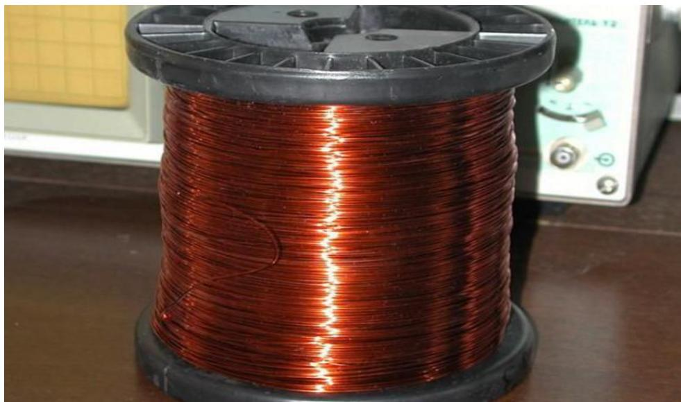
**ПЭВ – 1** провод с высокопрочной эмалью на основе винифлекса. Рабочая температура до  $110^{\circ}$ ,  $U_{пр}=350 - 1400В$ .
