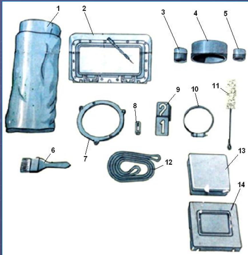
1 – коврик утеплительный; 2 – передний щиток колпака водителя; 3,4,5 – шланги соединительные; 6 – кисть; 7 – рамка передняя осветителя ОУ-ЗГКУ; 8 – амортизатор для крепления воздухоочистителя; 9 – пакет цифр; 10 – хомут для крепления шланга на патрубке воздухоочистителя; 11 – ерш для чистки циклонов; 12 – прокладка под крышку воздухоочистителя; 13 – пенал для электроламп; 14 – кронштейн для крепления прибора ТВНЕ-4ПА по походному
