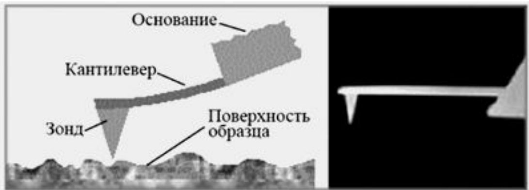
Схематическое изображение и электронная микрофотография типичного кантилевера с зондом
