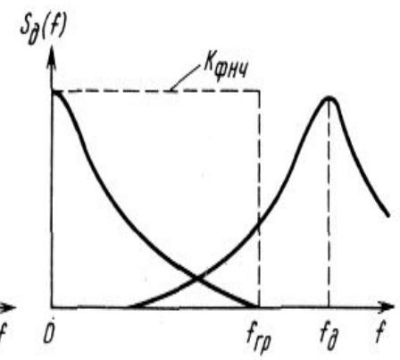
Рис. 5.4. Перекрытие спектров при  $f_d < 2f_{\text{гр}}$
