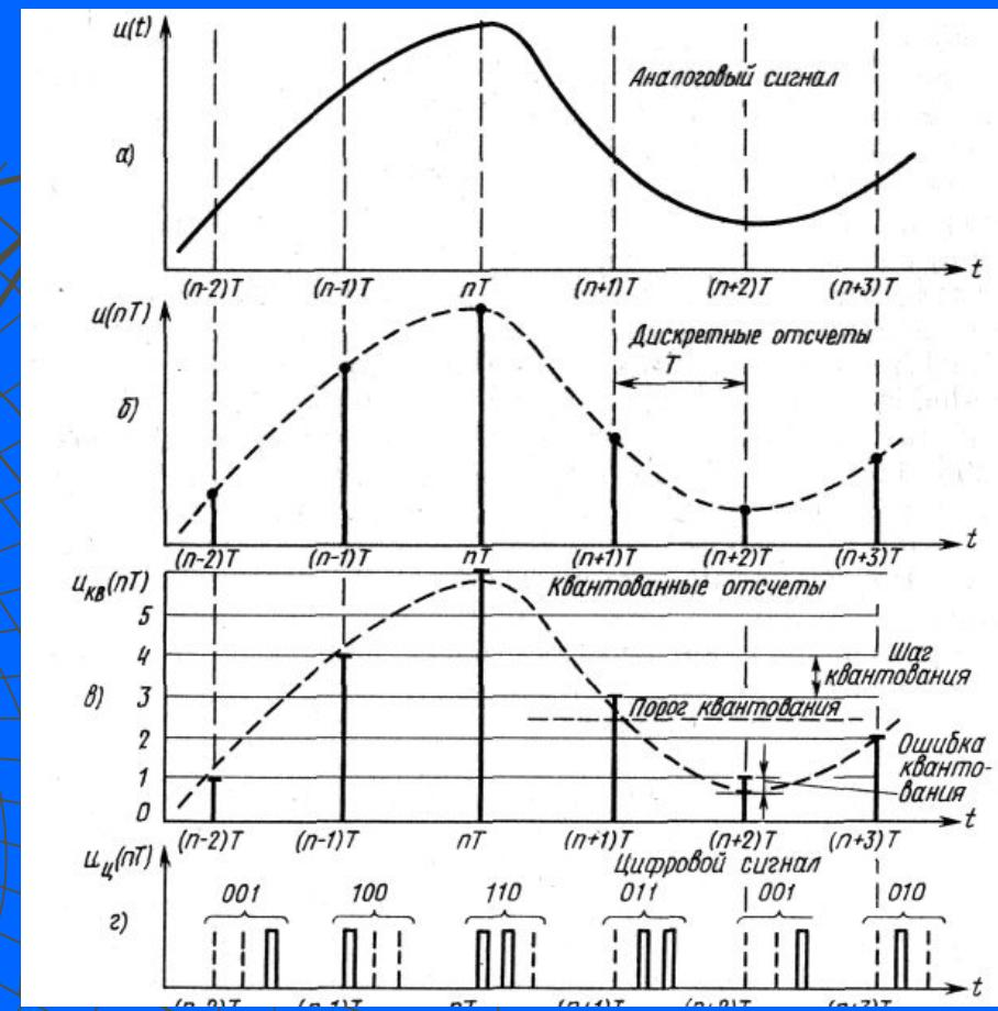
Дискретизация, квантование и кодирование видеосигнала
