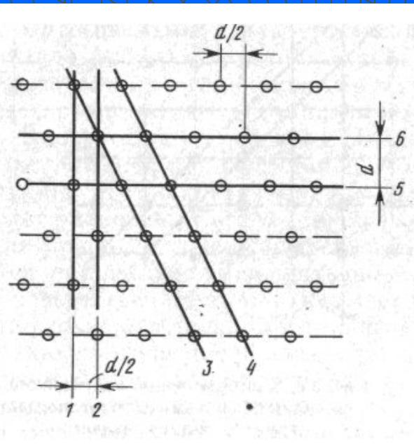
Если расположить отсчеты в соседних строках так, чтобы они были смещены друг относительно друга на половину шага дискретизации (половину размера одного элемента изображения)  $d/2$ , то будет образована шахматная структура отсчетов. Она позволяет без существенного ущерба качеству изображения снизить минимально допустимую частоту дискретизации с 12 МГц (при ортогональной структуре) до 8...8,5 МГц и соответственно пропорционально уменьшить цифровой поток ТВ сигнала
