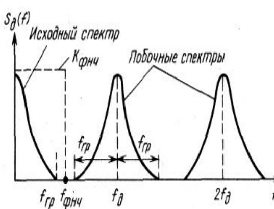
Рис. 5.3. Спектр сигнала после дискретизации
