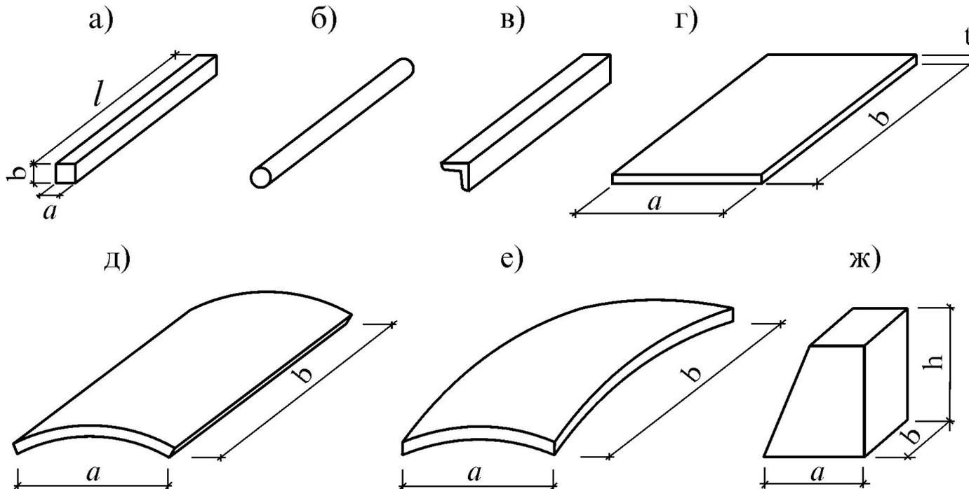
Простейшие сооружения, состоящие из таких элементов, можно подразделять на **стержневые сооружения**, **складчатые сооружения**, **оболочки** и **массивные сооружения**: подпорные стенки и каменные своды:
