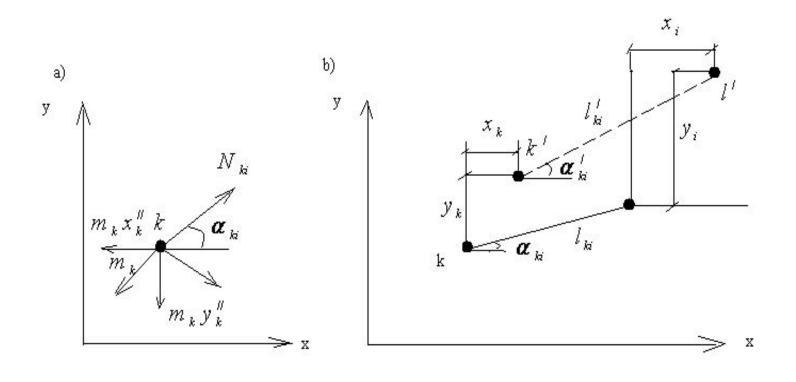
Перемещение узла і обозначим - х<sub>i</sub>, у<sub>i</sub>, а новое положение узлов точками - k<sup>/</sup> l<sup>/</sup>, а новая длина стержня кі будет l<sup>/</sup><sub>ki</sub>.
