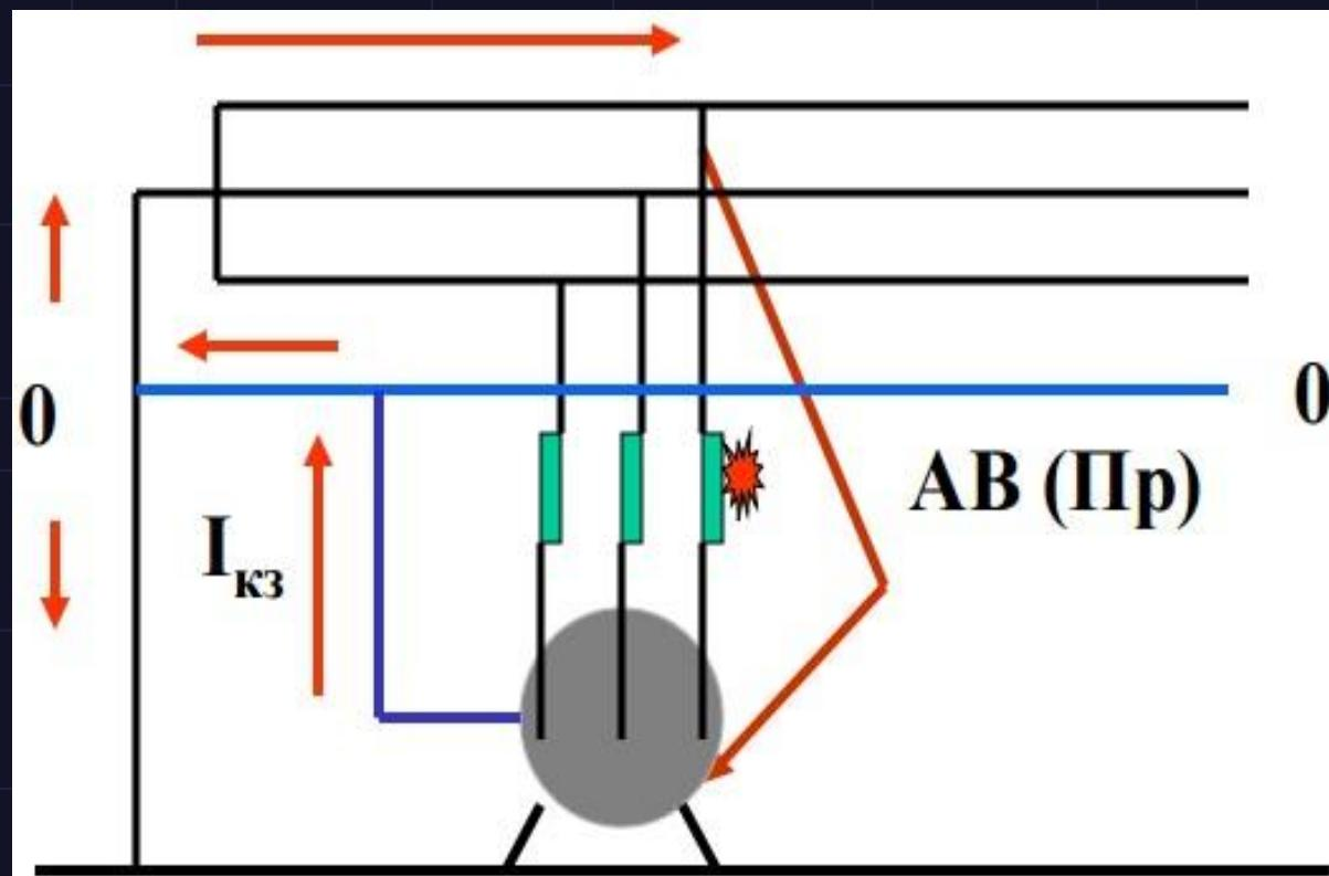
**Защитное действие зануления: при пробое изоляции на корпус образуется цепь с очень малым сопротивлением: фаза – корпус – нулевой провод – фаза. Следовательно, пробой на корпус при наличии зануления превращается в однофазное короткое замыкание. Возникающий в цепи ток резко возрастает, в результате чего срабатывает максимальная токовая защита и селективно отключает поврежденный участок сети.**
