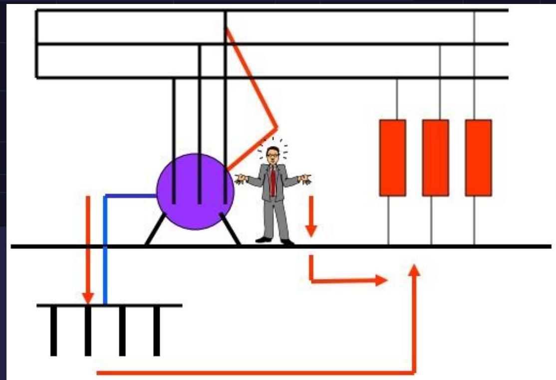
**Защитное действие заземления основано на снижении напряжения прикосновения при попадании напряжения на нетоковедущие части (вследствие замыкания на корпус или других причин), достигается уменьшением разности потенциалов между корпусом электроустановки и землей как из-за малого сопротивления заземления, так и повышения потенциала примыкающей к оборудованию поверхности земли. Чем меньше сопротивление заземления, тем выше защитный эффект.**
