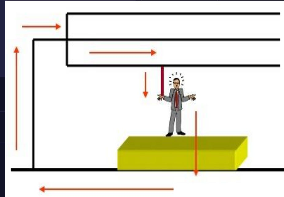
**В сети с заземленной нейтралью в случае прикосновения к голому фазному проводу он оказывается под фазным напряжением. Ток проходит через тело человека в землю и далее через заземление нейтрали в сеть.**
