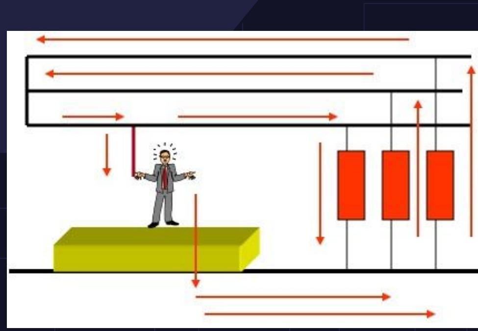
**В сети с изолированной нейтралью безопасные условия эксплуатации электроустановки зависят от изоляции проводов относительно земли, от сопротивления основания и обуви. Но в сетях с большой емкостью относительно земли роль изоляции проводов в обеспечении безопасности прикосновения утрачивается.**
