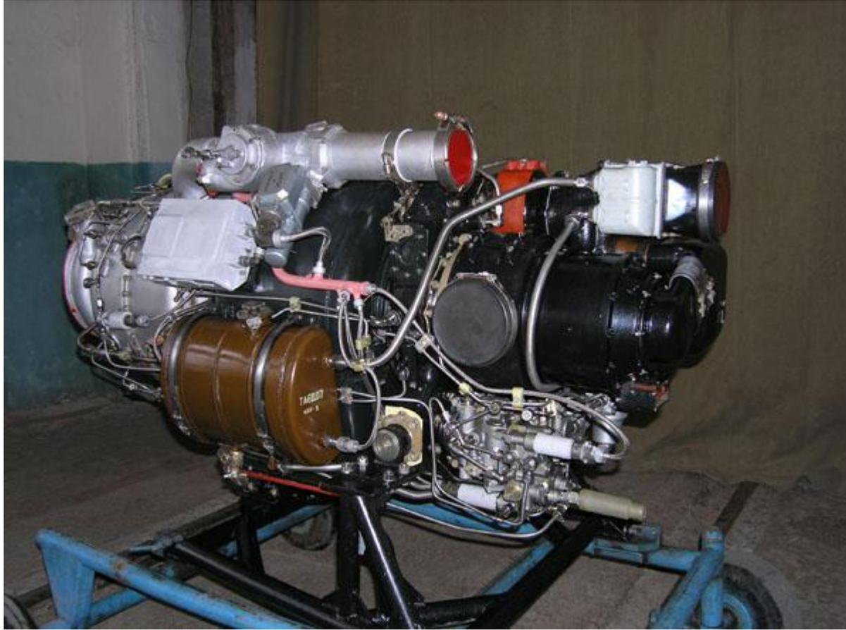
**Предназначена да обеспечения запуска газотурбинных двигателей самолетов на аэродромах с высотой расположения до  $H = 4200$  м (для самолета Ан-32 до  $H = 4500$  м) и питания бортовой сети самолета как во время подготовки к полету, так и в полете на высотах до  $H = 4200$  м (в последнем случае - как аварийный источник тока).**
