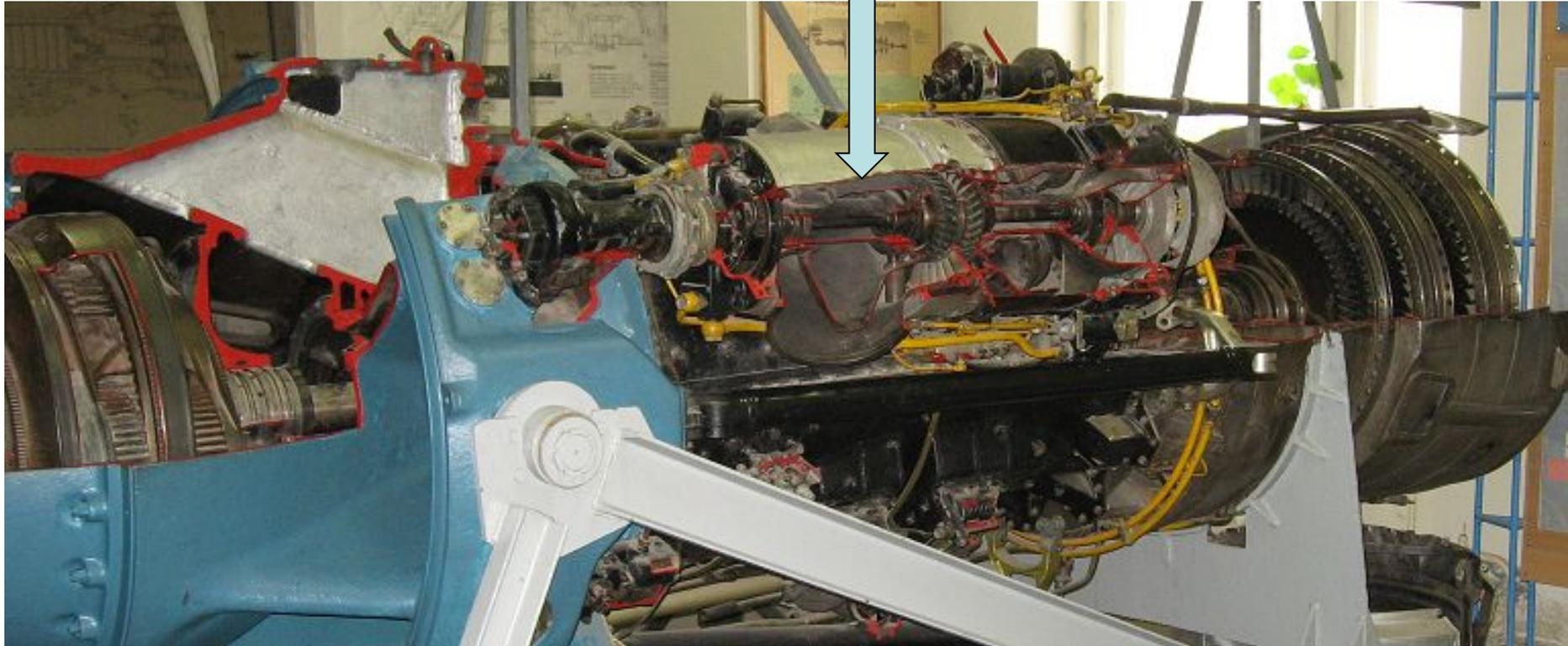
**Турбостартер расположен параллельно оси двигателя и связан с ним приводным валом-шестерней, расположенным по нормали к оси двигателя**
