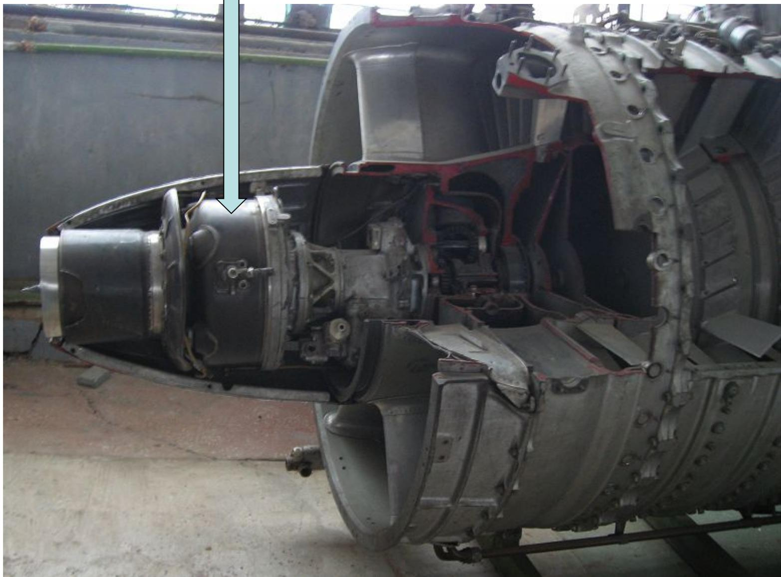
Турбостартер расположен на оси двигателя
