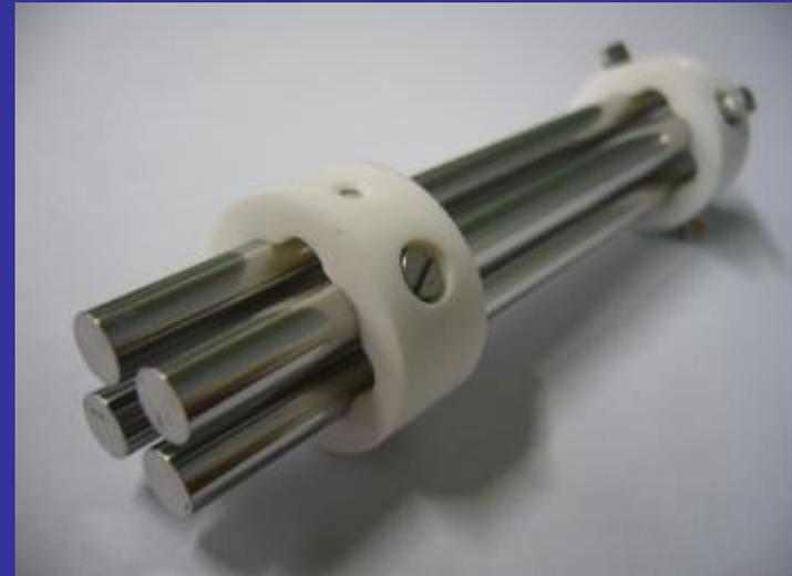
Квадруполь состоит из 4-х параллельных стержней
