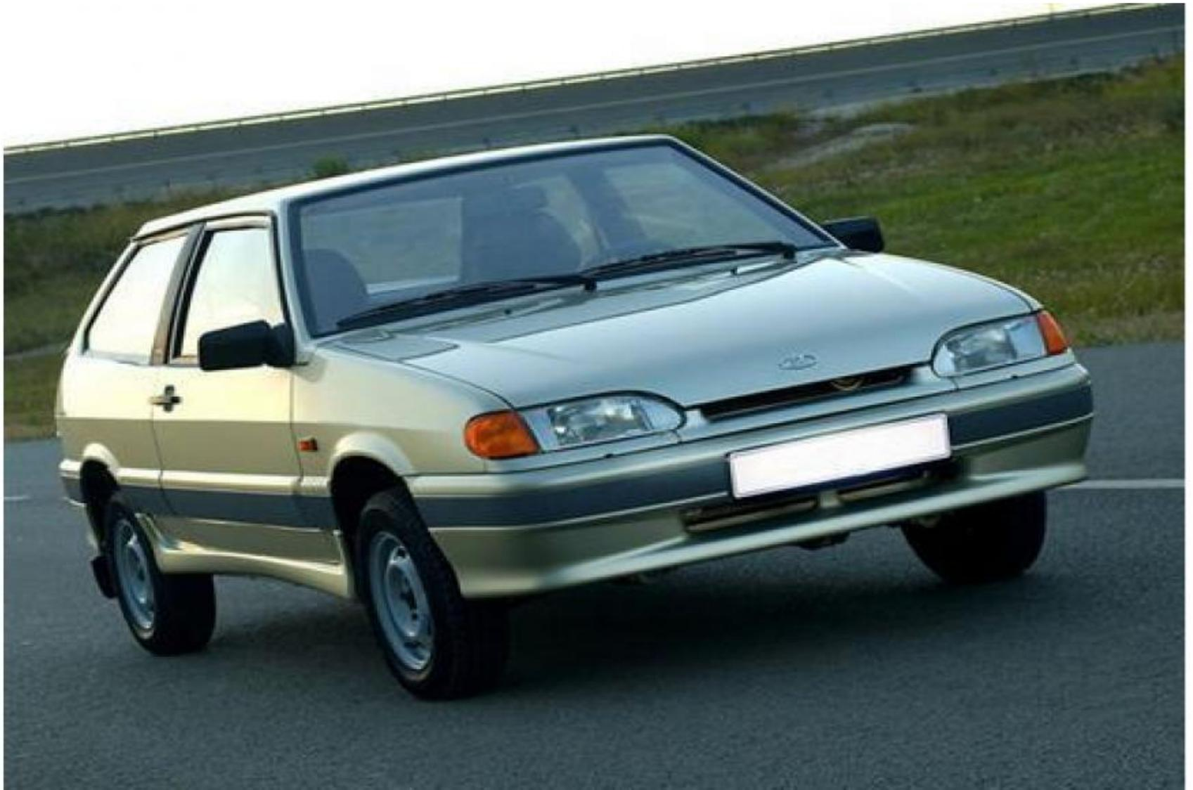
Классифицируют легковые автомобили и *по общей компоновке*: на автомобили, сделанные по классической, заднеприводной и переднеприводной схемам. При переднеприводной схеме компоновки двигатель располагается спереди, и передние колеса являются ведущими и управляемыми.
