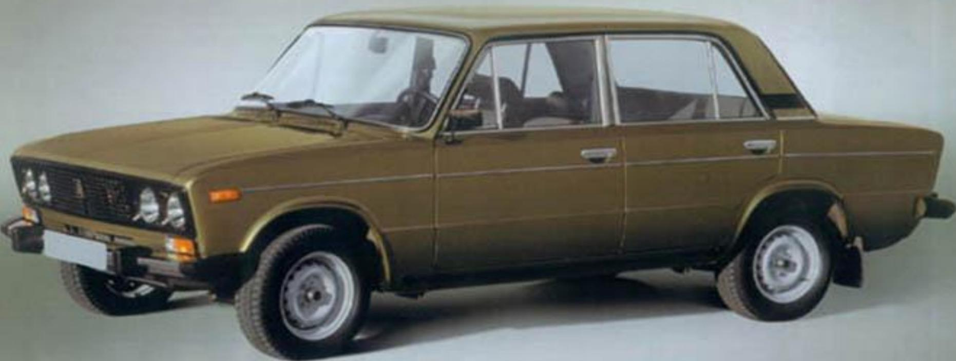
В обозначениях базовых моделей легковых автомобилей первые две цифры четырехзначного числа означают индекс автомобиля (11, 21, 31, 41) в зависимости от рабочего объема двигателя, а последние две цифры — номер модели. Буквы перед цифрами означают завод-изготовитель. Например, ВАЗ-2108 «Спутник» означает, что автомобиль изготовлен ОАО «ВАЗ». Это автомобиль малого класса с рабочим объемом двигателя 1,1... 1,8 л, 08 — номер модели.
